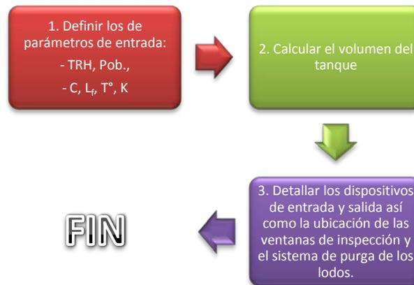
Figura 3-12. Esquema para el diseño del tanque séptico.
