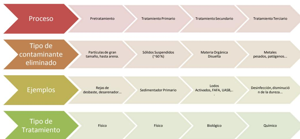
**Figura 2-2.** Esquema de una PTAR tradicional.
