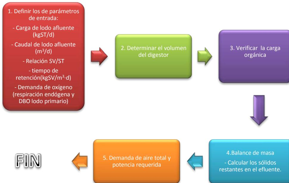
**Figura 3-31.** Esquema para el diseño de un digester aeróbico
