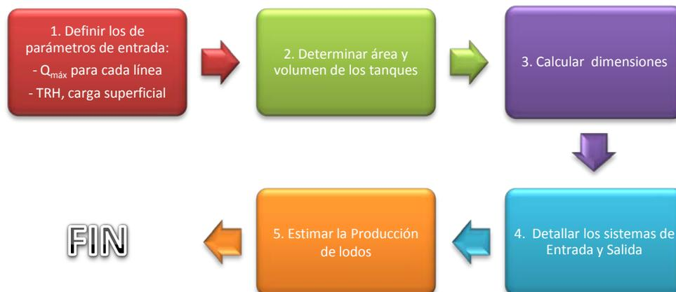
Figura 3-13. Esquema de diseño para el sedimentador primario.
