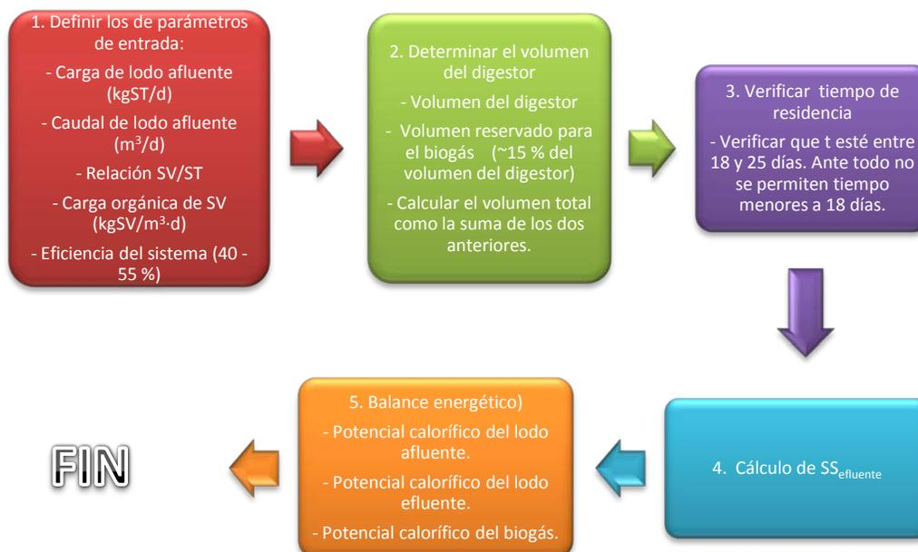
**Figura 3-33.** Esquema para el diseño de un digester anaeróbico
