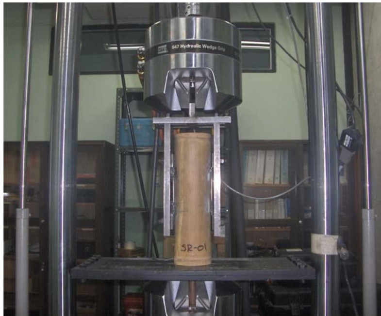
Figura 45: Probeta de bambú junto con el soporte diseñado e instalado en la máquina universal
