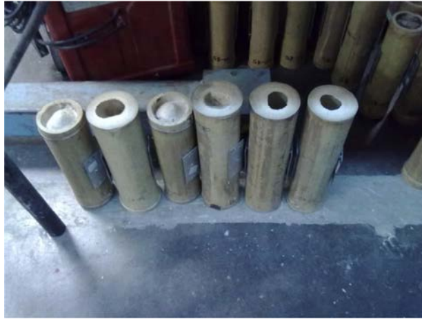
Figura 36: Probetas de guadua angustifolia utilizadas en el proyecto
