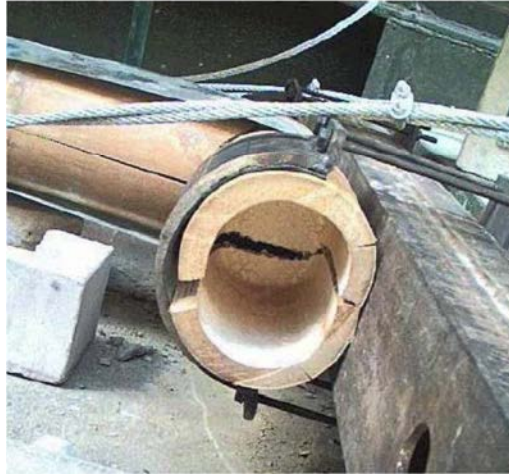
Figura 16: Falla en elemento de bambú por compresión perpendicular a la fibra.
