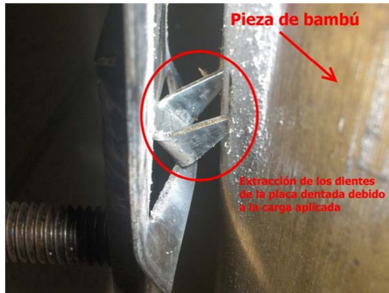
Figura 50: Falla de la placa dentada de la unión universal metálica
