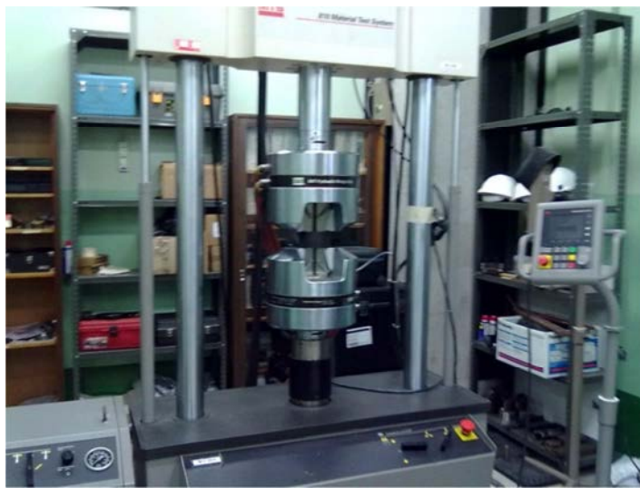
Figura 44: Máquina universal MTS-810 para ensayos a tensión, compresión, fatiga, fractura mecánica y durabilidad en diferentes tipos de materiales
