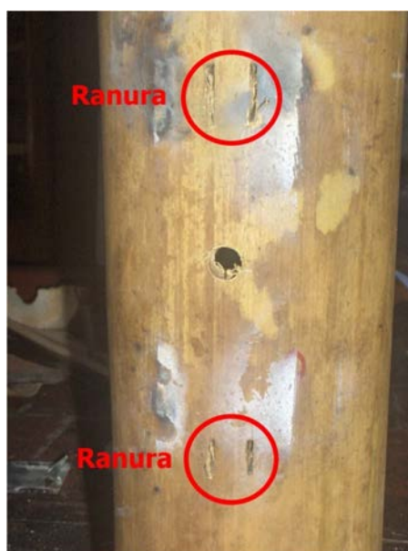
Figura 49: Ranuras de falla en la guadua debidas al desplazamiento de los dientes
