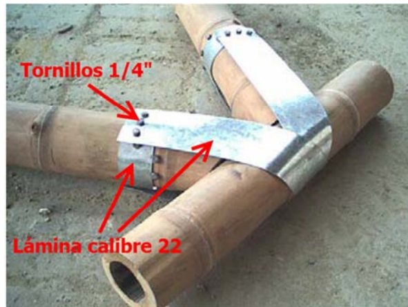
Figura A-82: Fotografía, unión Sandra Clavijo
