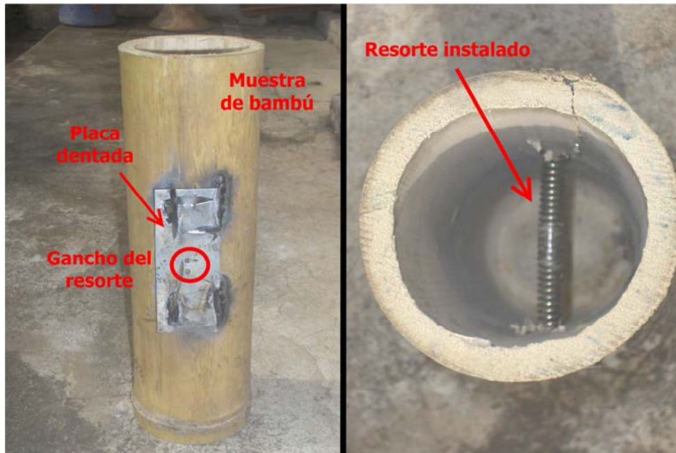
Figura 40: Resorte tipo 432 instalado en unión metálica universal
