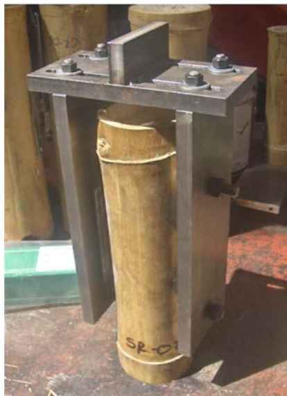
Figura 42: Soporte instalado a la muestra de bambú con la unión
