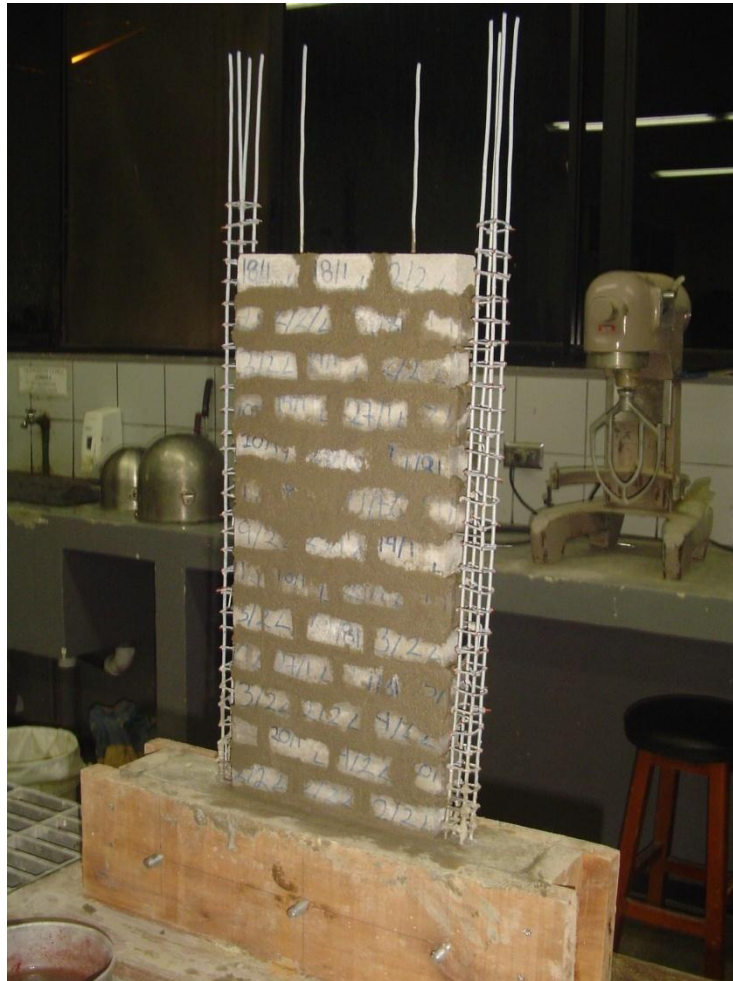
Figura 39. Paño de mampostería del muro confinado
