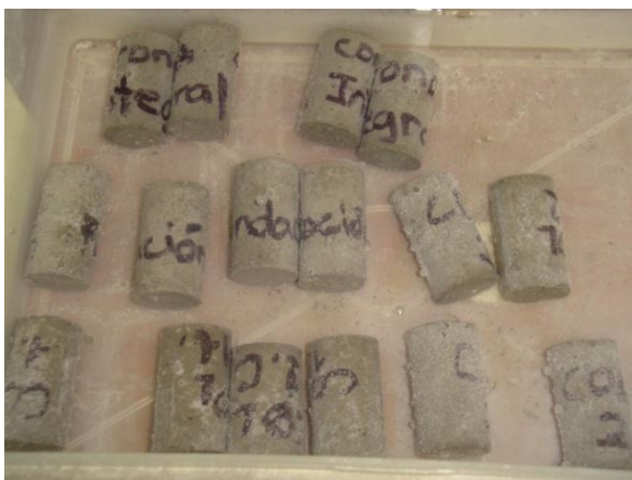
Figura 24. Cilindros de microconcreto de curado
