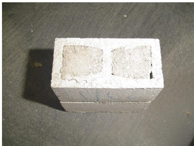
Figura 26. Prismas de mampostería rellenos
