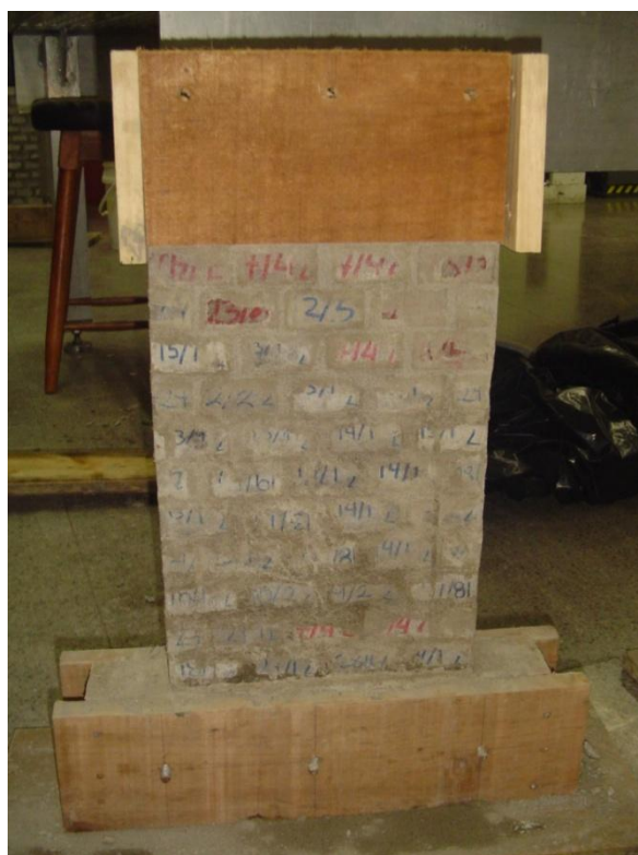
Figura 46. Encofrado de la viga corona de los muros integrales
