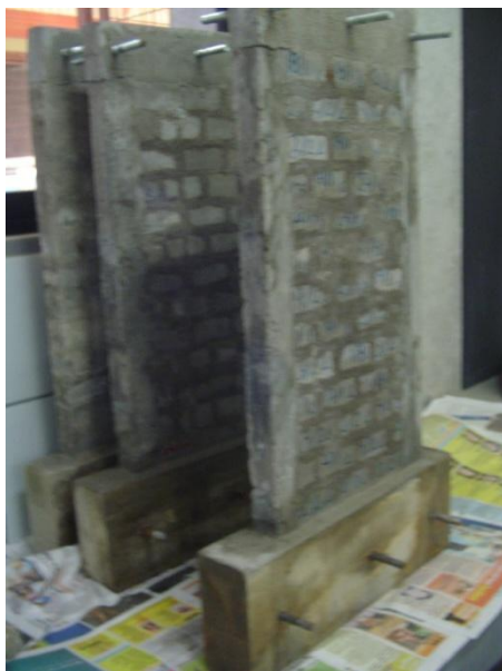
Figura 52. Muros después de su proceso de desencofrado.
