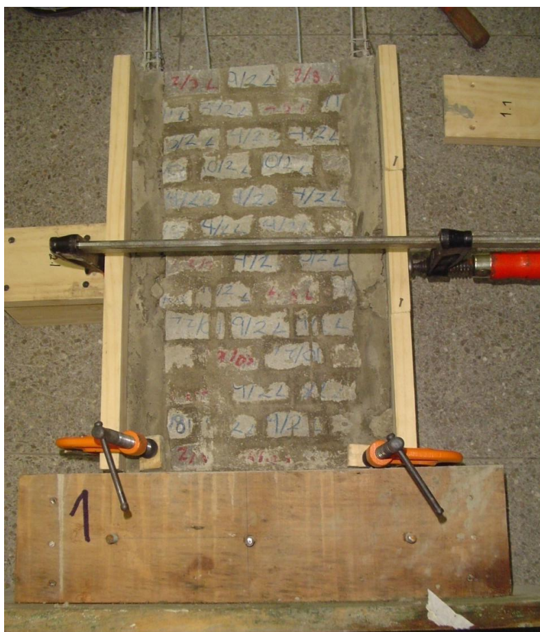
Figura 44. Finalizado la colada de las columnas
