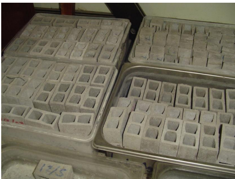
Figura 10. Curado de los bloques de mampostería
