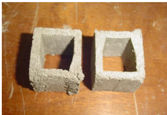
Figura 17. Bloques modulares para el paño de mampostería
