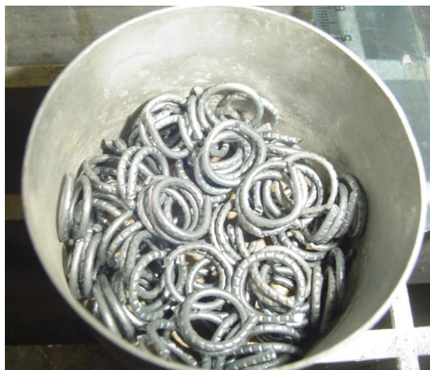
Figura 29. Aros de confinamiento terminados
