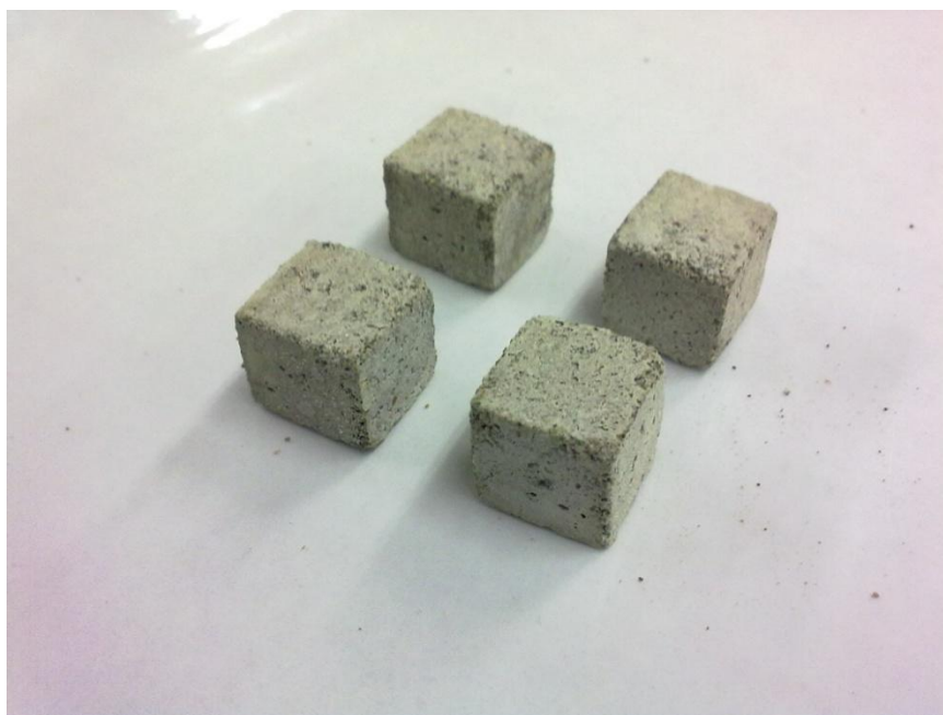
Figura 22. Cubos de falla del mortero
