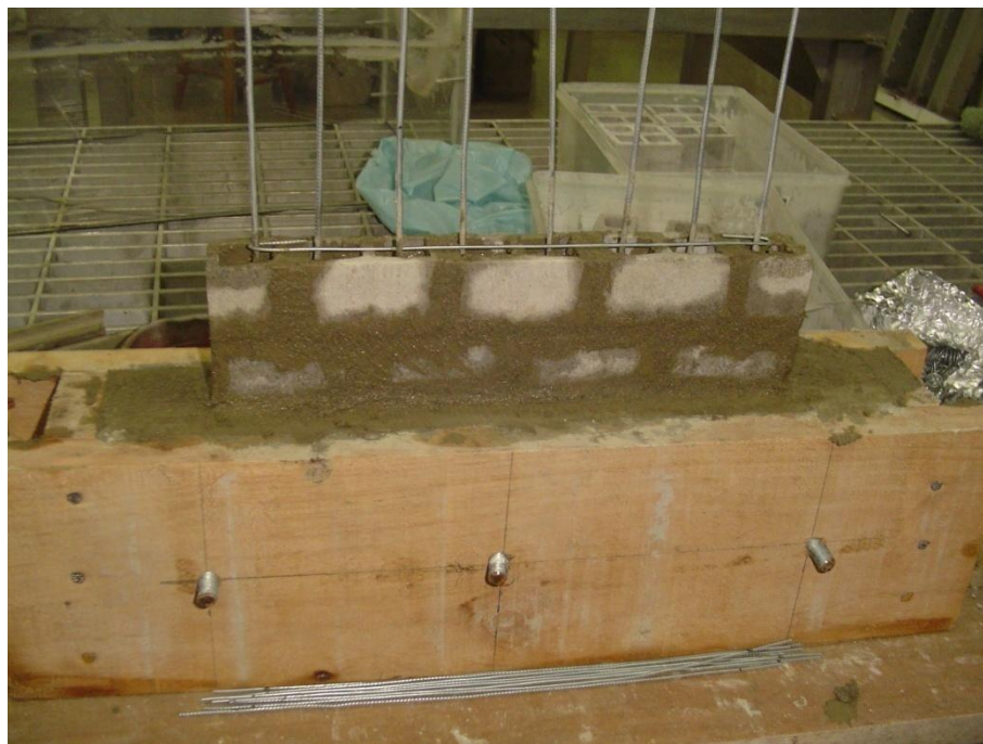
Figura 40. Pega de bloques del muro integral
