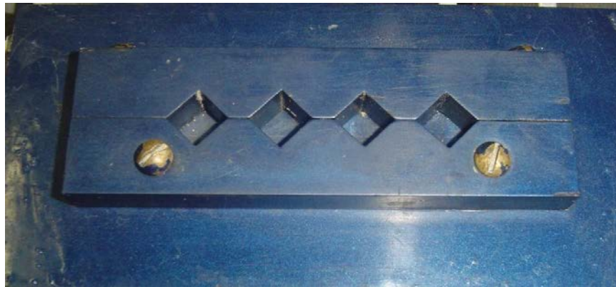
Figura 87. Molde de los cubos de microconcreto de mortero.
