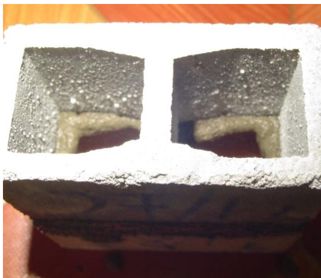
Figura 27. Prismas de mampostería vacíos
