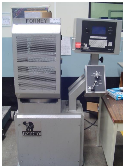
Figura 14. Equipo de falla. FORNEY F-50C-DFM/I
