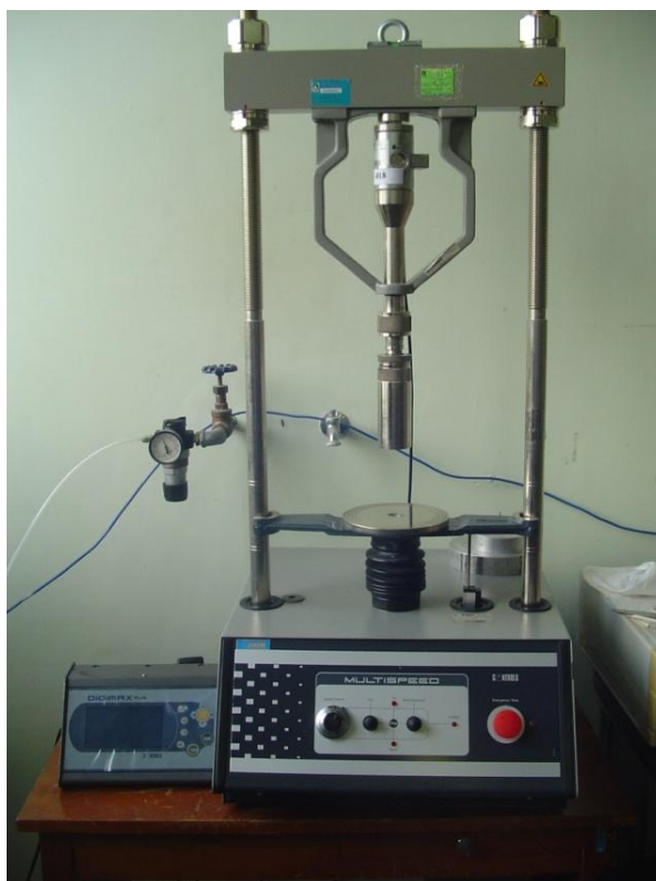
Figura 15. Equipo de falla. Controls 82-P0326/DB
