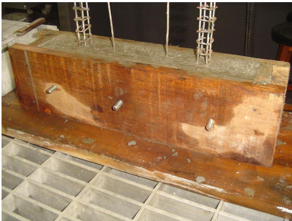
Figura 33. Encofrado y colada de la viga fundación
