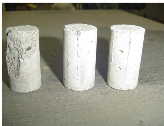
Figura 25. Muestras cilíndricas en su proceso después de la falla
