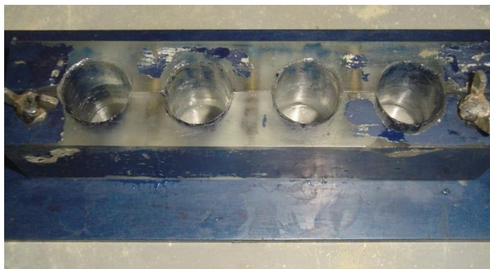
Figura 88. Molde de los cilindros de microconcreto de relleno.
