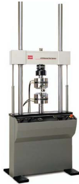
Figura 20. Equipo de falla. MTS Material Test System
