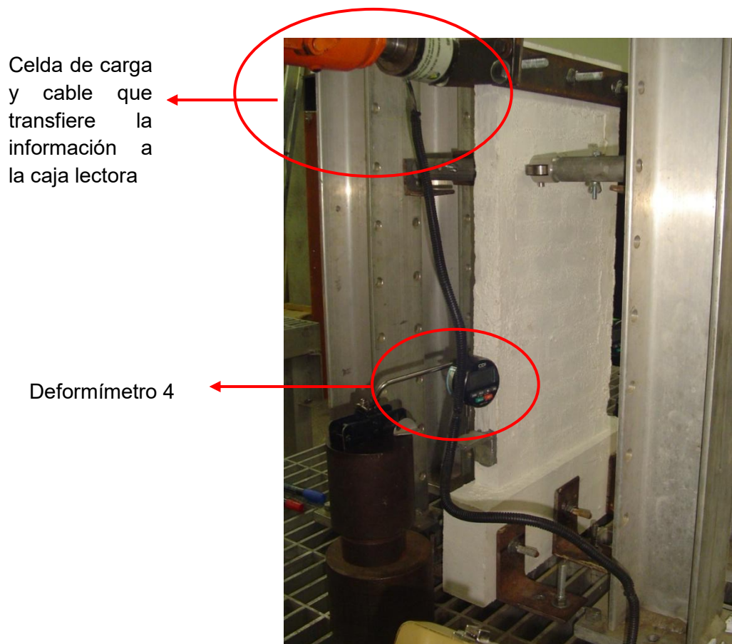
Figura 58. Deformímetro 4 y celda de carga colocados para la falla
