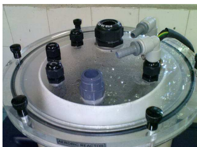
Figura 27: Reactor Aerobio y acercamiento del minitanque que contiene el agua residual tratada, respectivamente.
