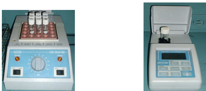
Figura 22: Digestor de DQO y Colorímetro utilizados para pruebas de DQO.
