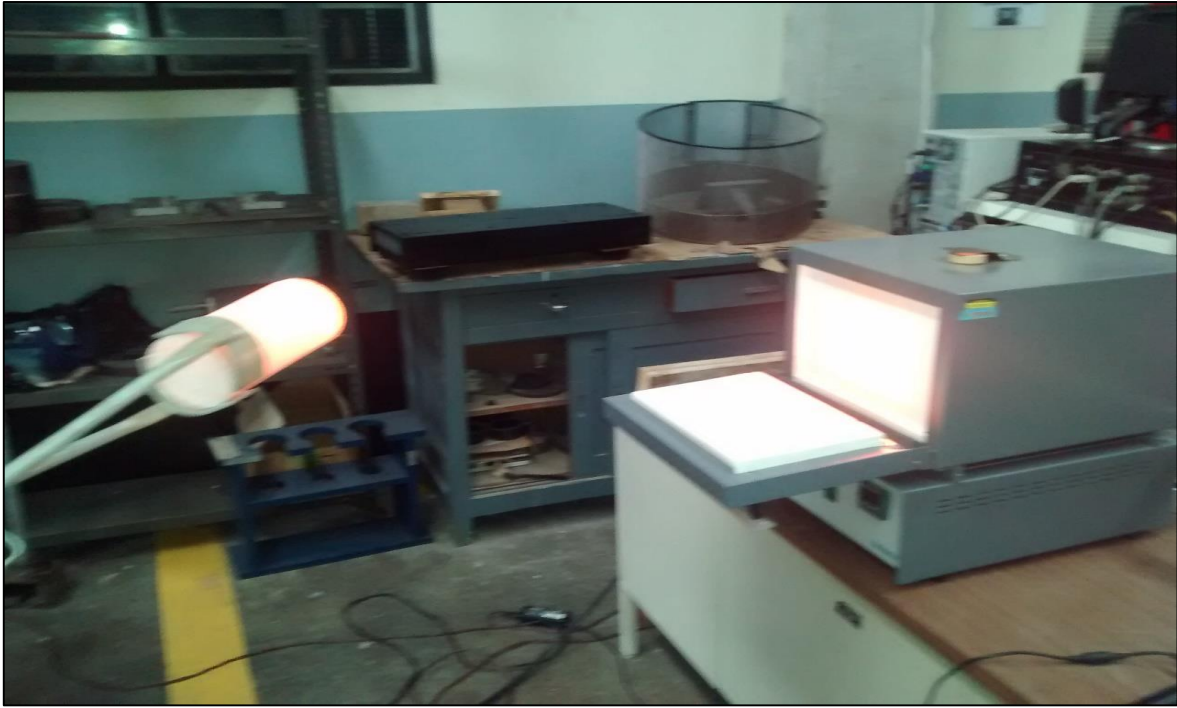
Imagen 83: Extracción de cilindros antes de ser fallados.
