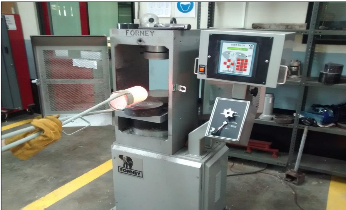
Imagen 84: Extracción de cilindros antes de ser fallados.
