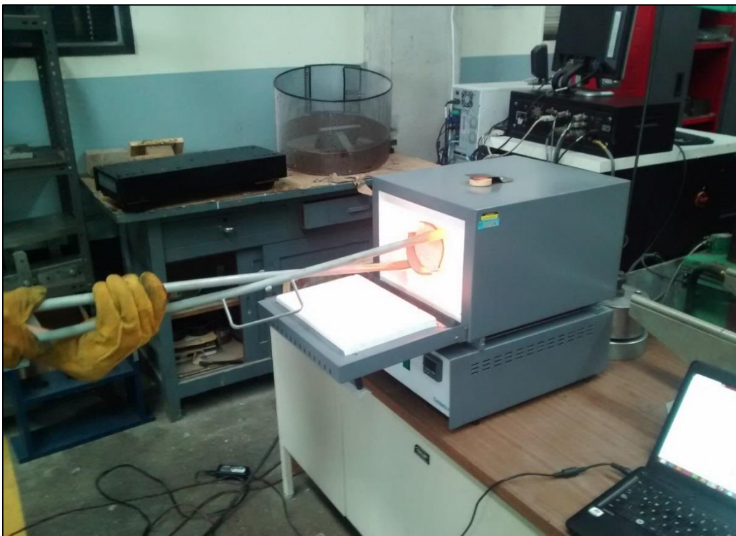
Imagen 82: Extracción de cilindros antes de ser fallados.
