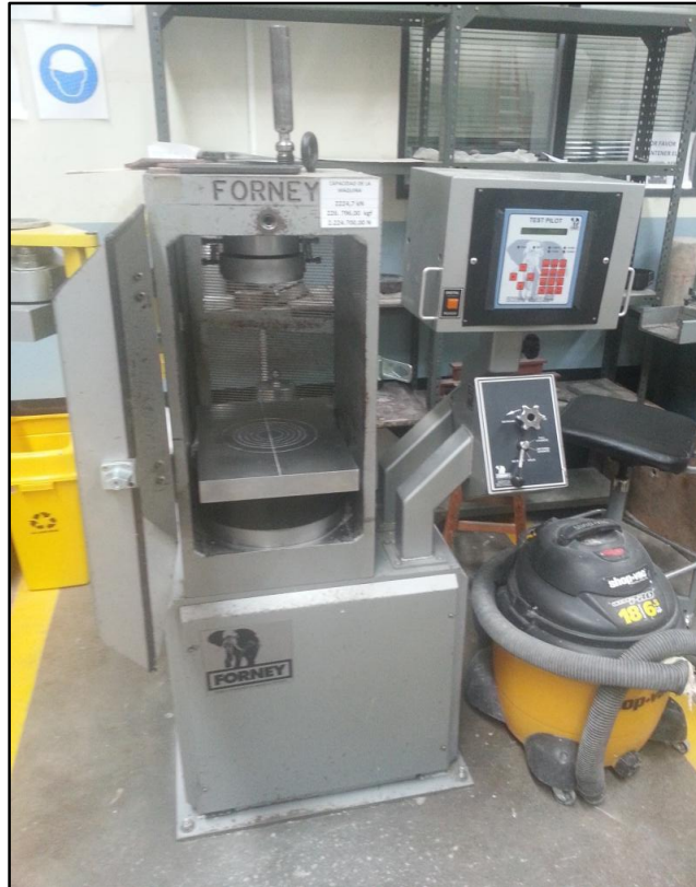
Imagen 28. Equipo de falla por compresión Forney modelo: F-50C-DFM/I.
