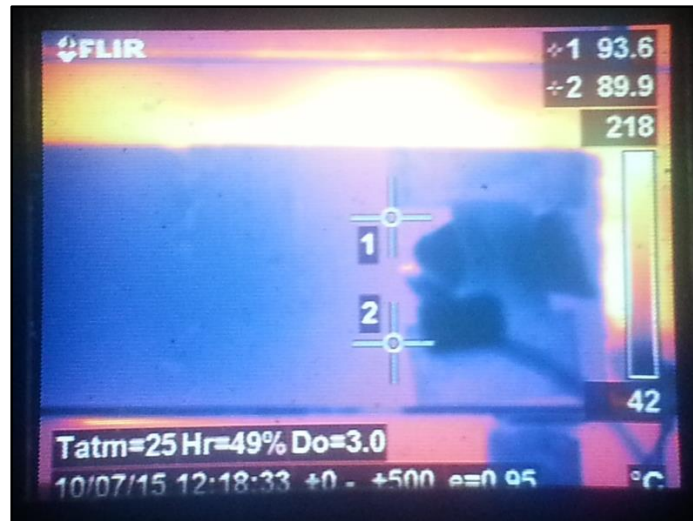
Imagen 45. Fotografía de una termografía obtenida en tiempo real durante las mediciones de la temperatura en la superficie no expuesta de las losas de concreto estudiadas.
