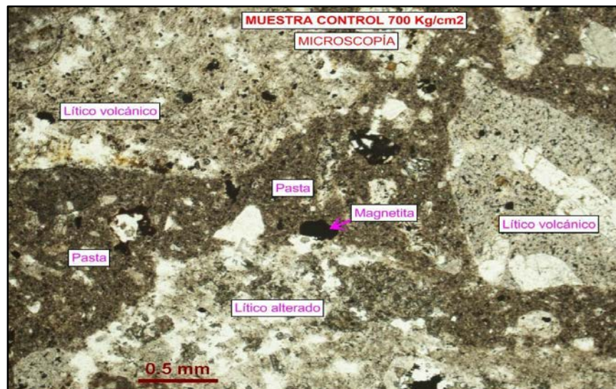
Imagen 96: Muestra de control del concreto de 700 kg/cm 2
