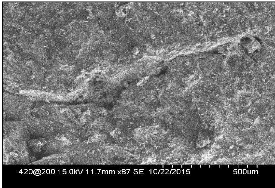
Imagen 102: Imagen del concreto calentado a 200 °C.
