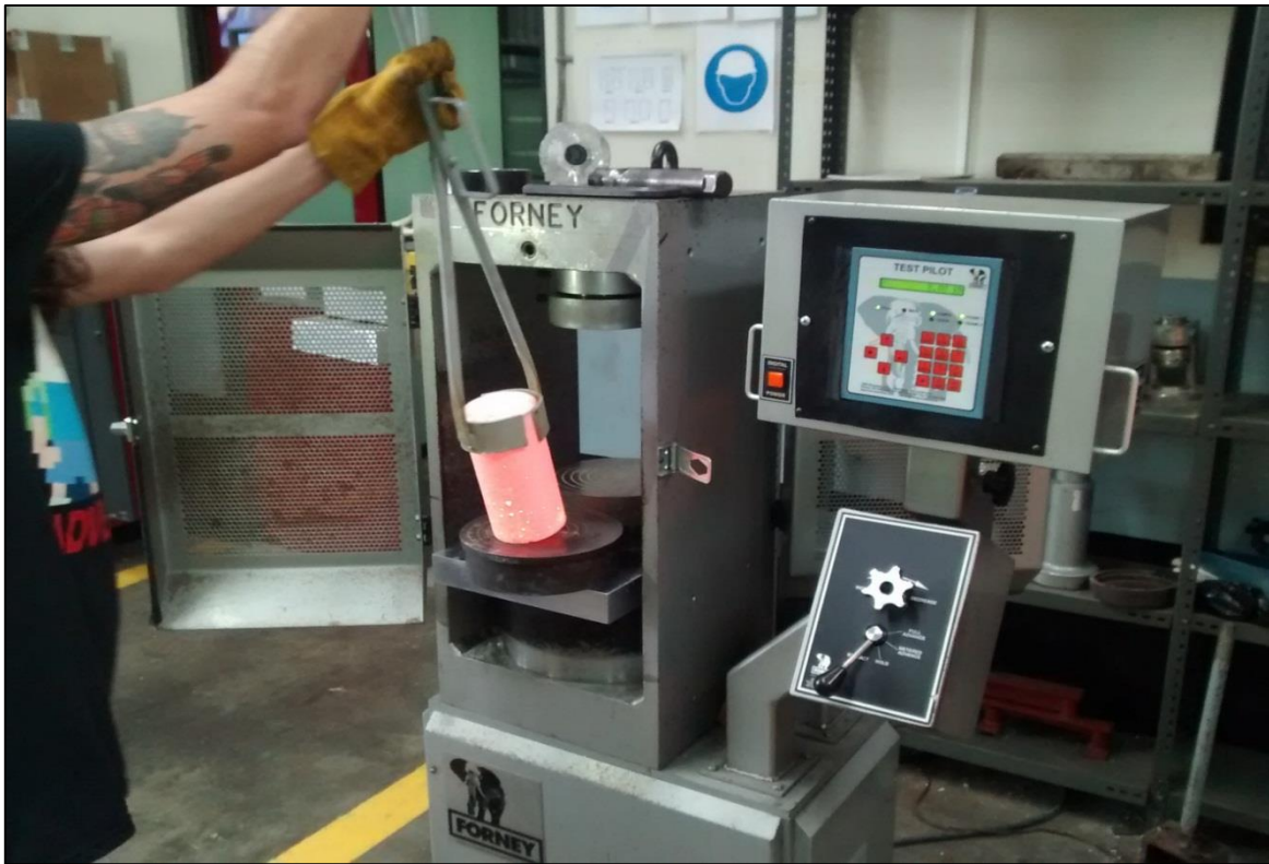
Imagen 85: Extracción de cilindros antes de ser fallados.
