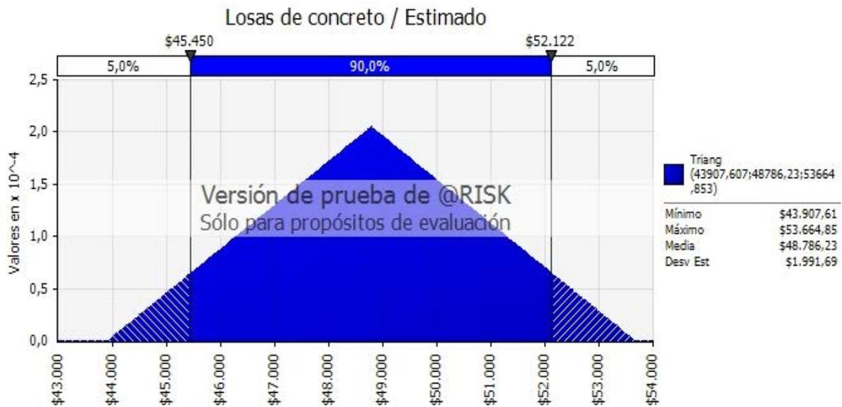
**Figura C 11. Caso 2: Distribución triangular "Losas de concreto"**
