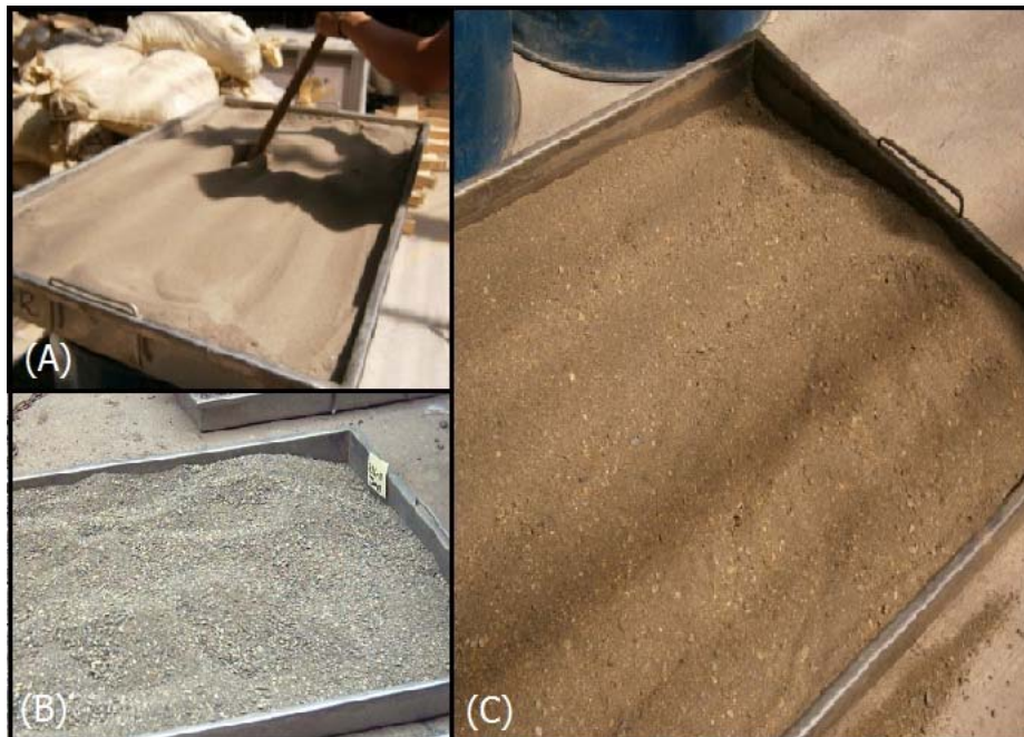
Figura 5.40: Mezcla de arena de playa (A) con arena de Río (B), para obtener una mezcla de proporción 50/50 (C)
