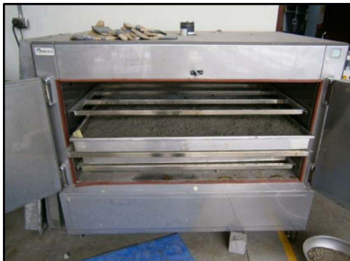
Figura 5.38: Arena colocada en bandeja y puesta al horno a 110°C
