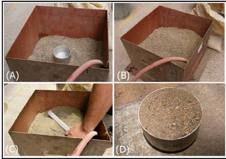
Figura 5.42: Proceso para determinar el peso volumétrico de las muestras ensayadas a escala reducida.
