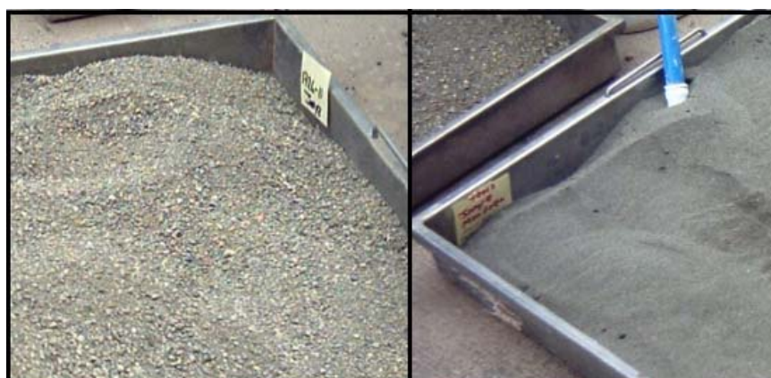
Figura 5.30: Arena de río de Guápiles (izquierda) y arena de playa Esterillos (derecha) utilizadas para los ensayos de escala reducida
