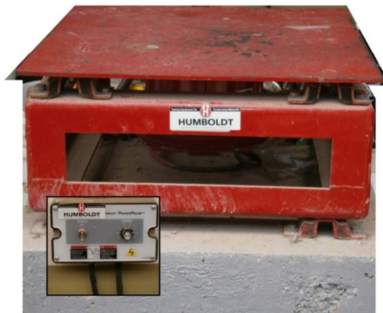
Figura 5.36: Equipo vibratorio del LanammeUCR
