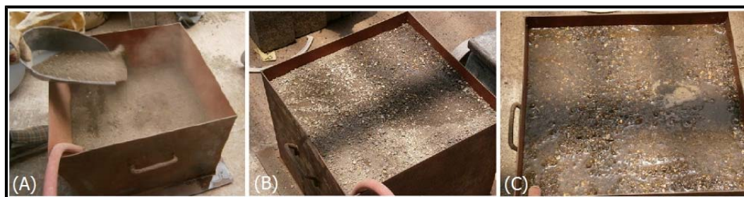
Figura 5.41: Deposición y saturación del material ensayado
