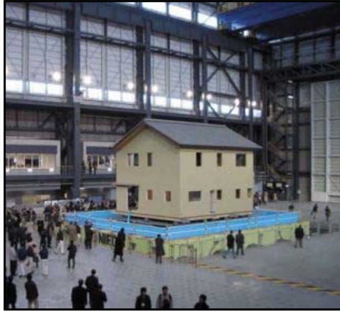
Figura 4.28: Mesa vibratoria "E-Defense" instalada en Japón, lista para ensayar una casa a gran escala.
