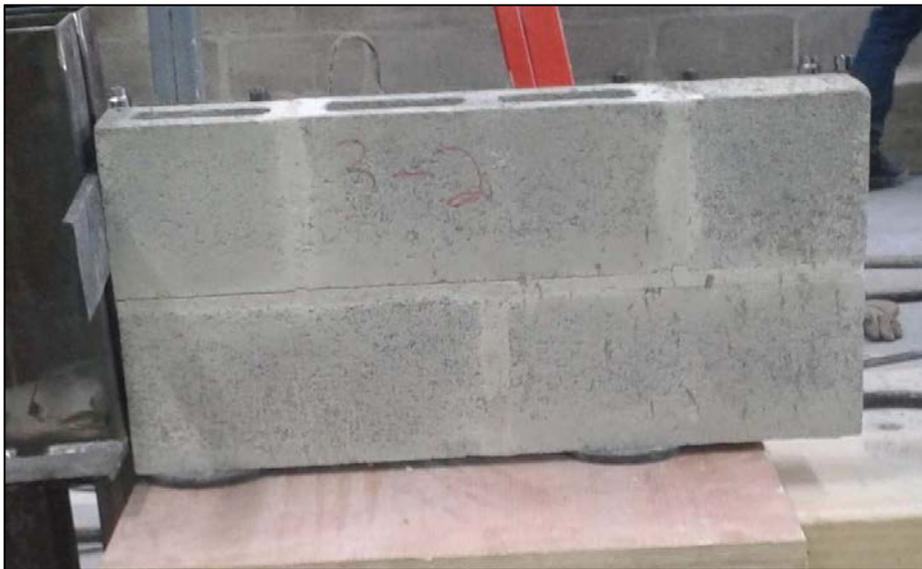
**Figura 97. Especimen 3-2, listo para empezar a fallar.**
