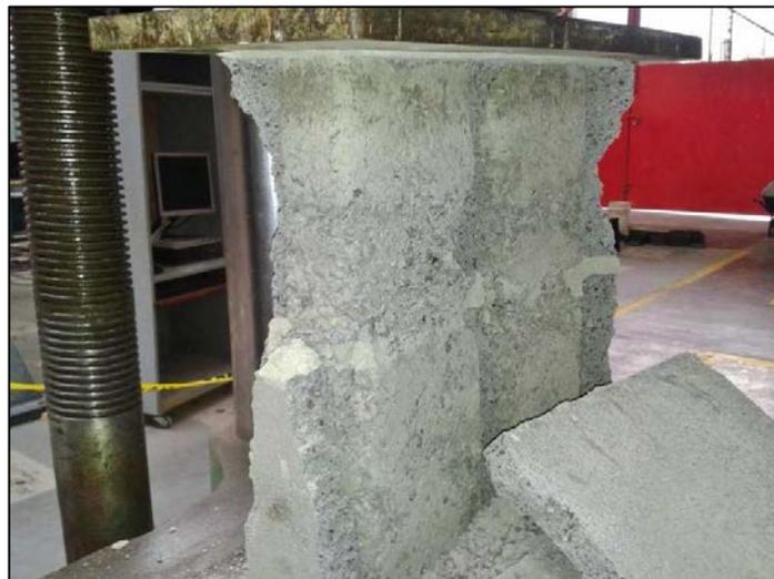
**Figura 8. Falla de un prisma de mampostería relleno.**
