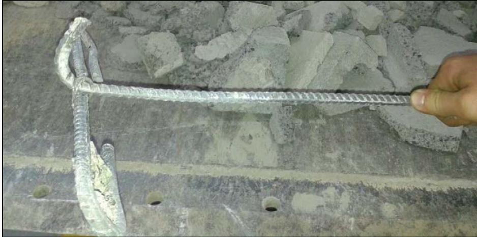
**Figura 123. Resultado de la falla espécimen 5-1, gancho estándar de 180° deformado.**
