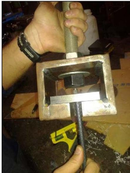
**Figura 58. Aditamento que conecta el gato hidráulico y la varilla de los especímenes.**
