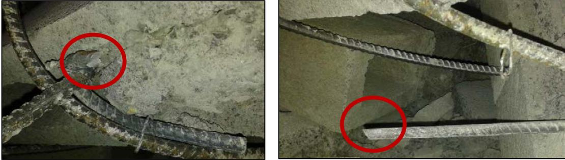
**Figura 133. Resultado de la falla espécimen 5-4, ruptura de la varilla.**
