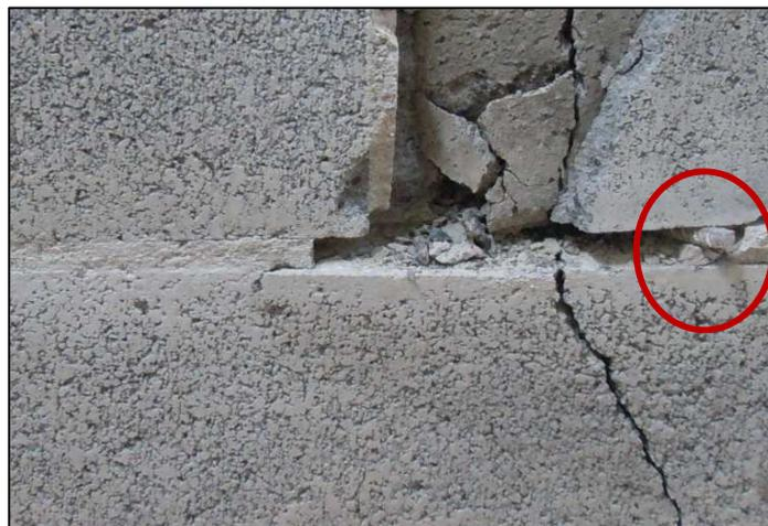
**Figura 120. Espécimen 4-5 al finalizar el proceso de falla.**
