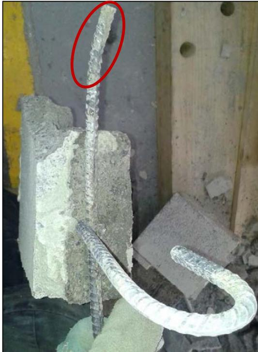
**Figura 90. Resultado de la falla, gancho estándar de 90° deformado, espécimen 2-4.**
