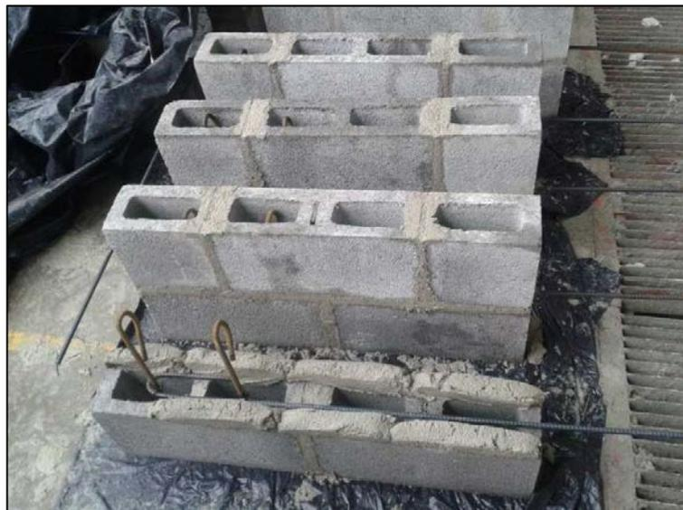
**Figura 47. Especímenes de cuarto extremo de pared en construcción.**
