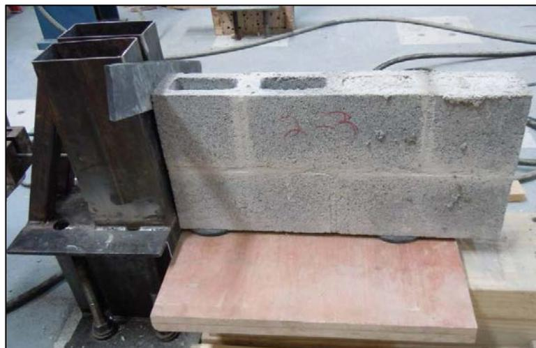
**Figura 86. Especimen 2-3 listo para empezar a fallar.**
