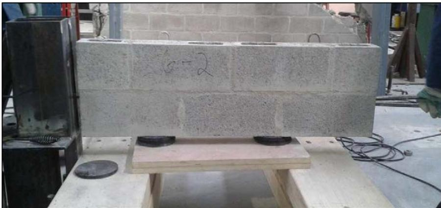
**Figura 140. Especímen 6-2 durante el proceso de falla.**
