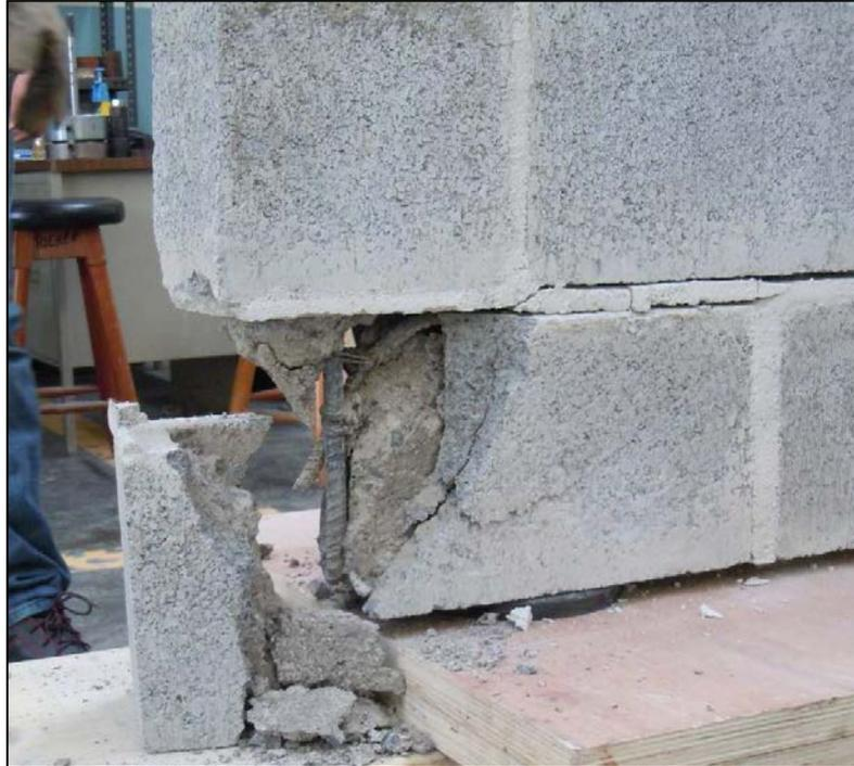
**Figura 78. Resultado de la falla, gancho estándar de 90° deformado, espécimen 1-5.**
