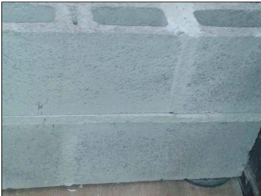
**Figura 101. Espécimen 3-3 durante el proceso de falla, los bloques se empiezan a separar del mortero de pega.**
