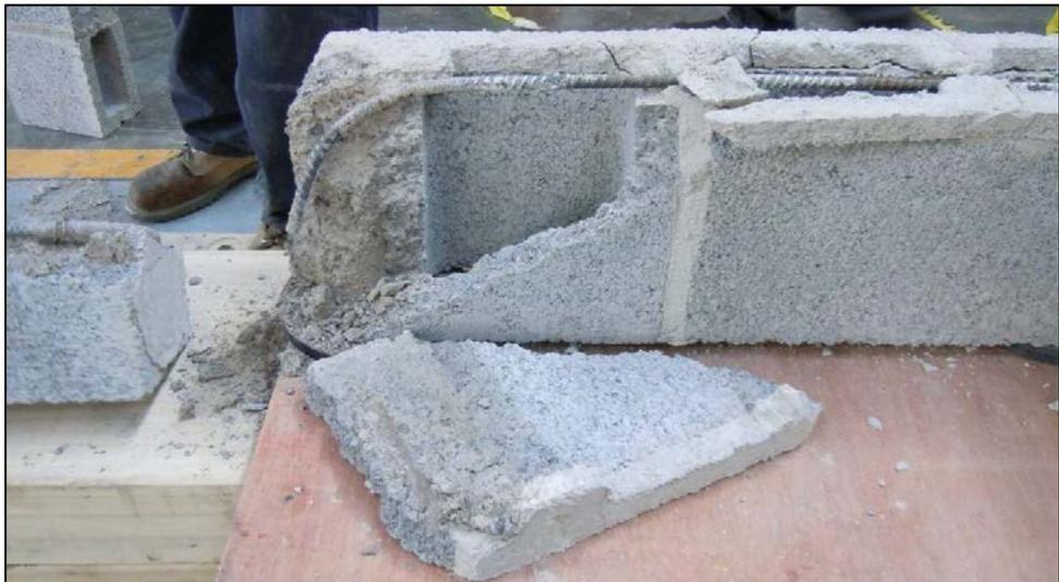
**Figura 75. Resultado de la falla, gancho estándar de 90° deformado, espécimen 1-4.**
