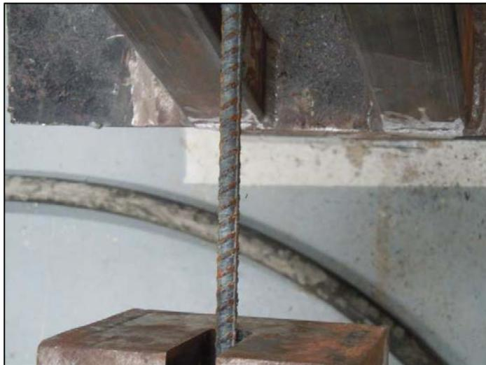
**Figura 114. Varilla del espécimen 4-3, durante el proceso de falla.**
