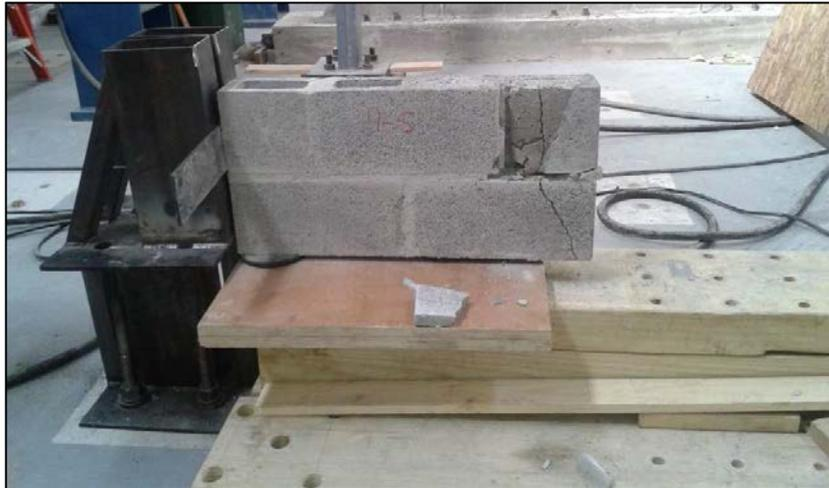
**Figura 119. Espécimen 4-5 durante el proceso de falla.**
