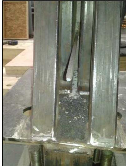
**Figura 146. Resultado de la falla espécimen 6-4, ruptura de la varilla.**
