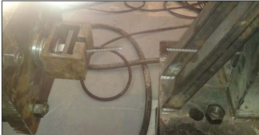
**Figura 107. Resultado de la falla, espécimen 4-1, ruptura de la varilla.**
