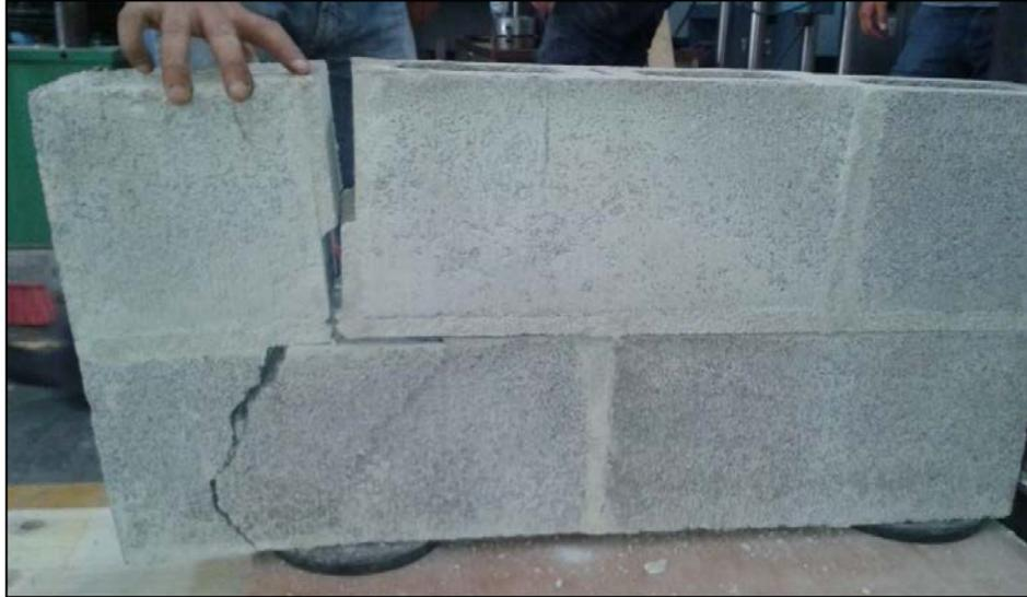
**Figura 72. Resultado de la falla espécimen 1-3, bloques quebrados.**
