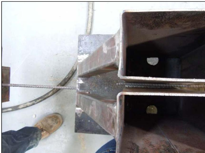
**Figura 84. Resultado de la falla, ruptura de la varilla, espécimen 2-2.**
