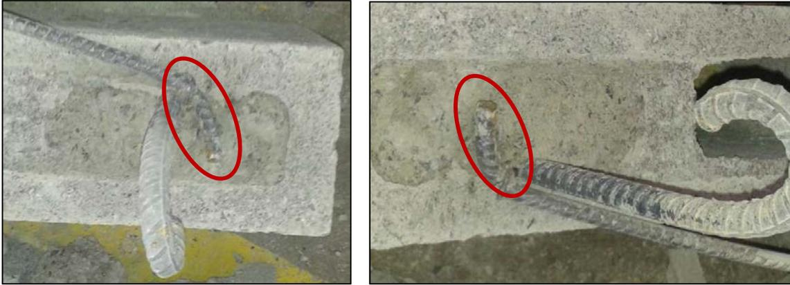
**Figura 98. Resultado de la falla, gancho estándar de 180° deformado, espécimen 3-2.**
