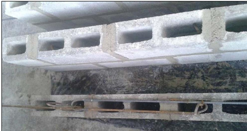
**Figura 49. Especímenes de primer tipo de traslapo en construcción.**
