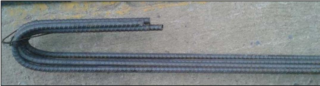
**Figura 33. Varilla horizontal #3 con gancho de 180°.**
