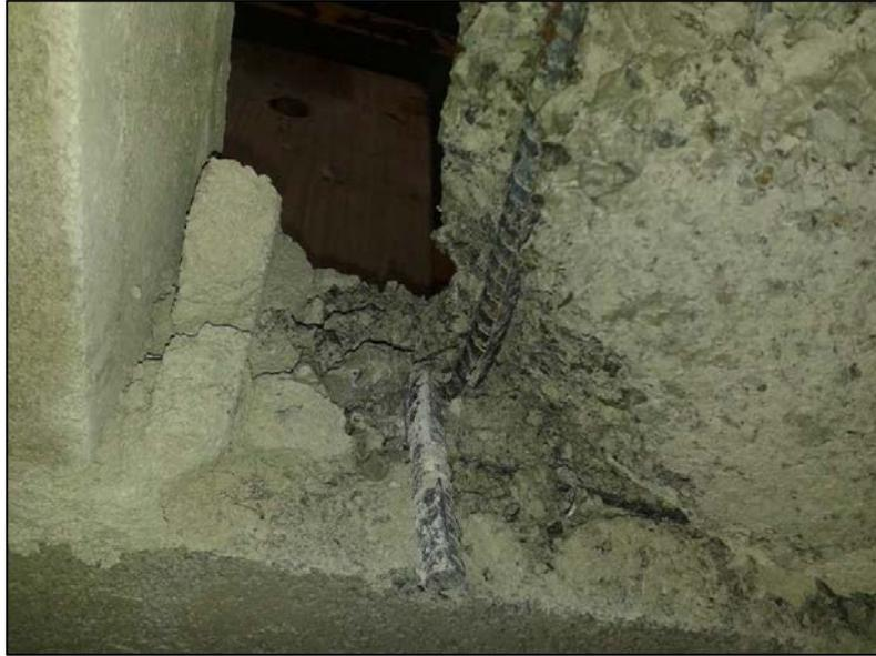
**Figura 127. Resultado de la falla espécimen 5-2, gancho estándar de 180° deformado.**
