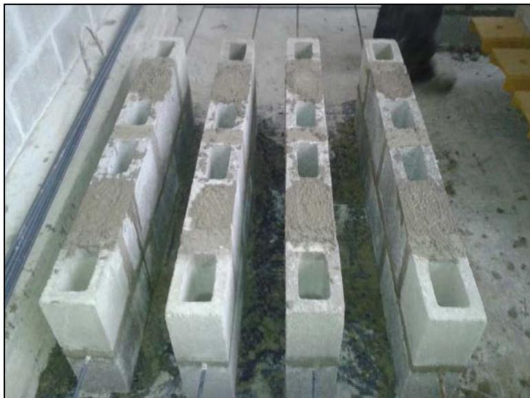
**Figura 53. Especímenes listos con concreto de relleno.**
