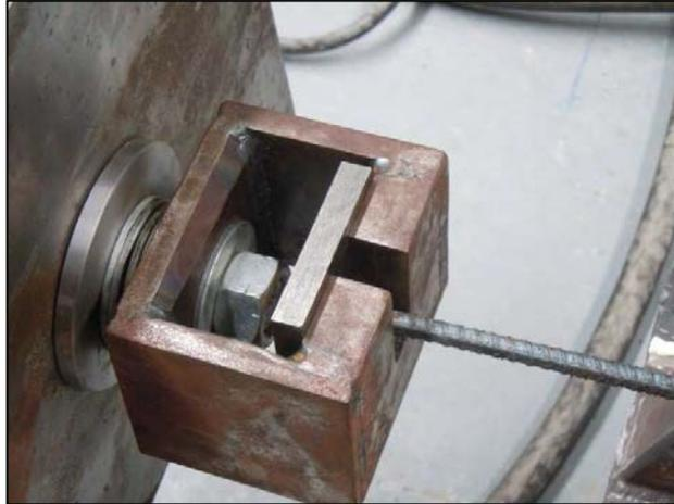
**Figura 111. Espécimen 4-2 durante el proceso de falla.**
