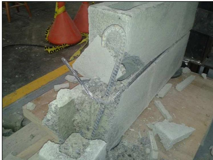
**Figura 104. Espécimen 3-4 al final de la falla, el gancho estándar de 180° se deformó.**
