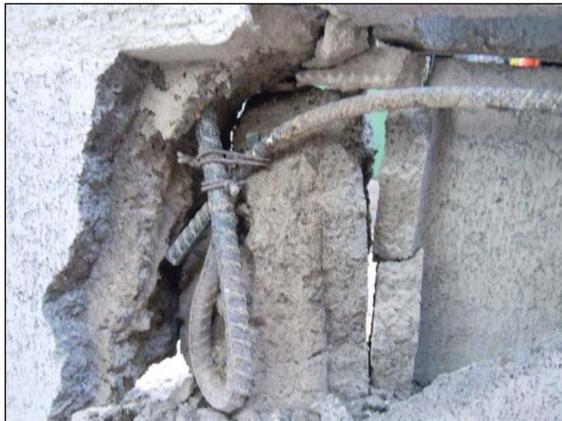
**Figura 69. Resultado de la falla, gancho estándar de 90° deformado, espécimen 1-2.**
