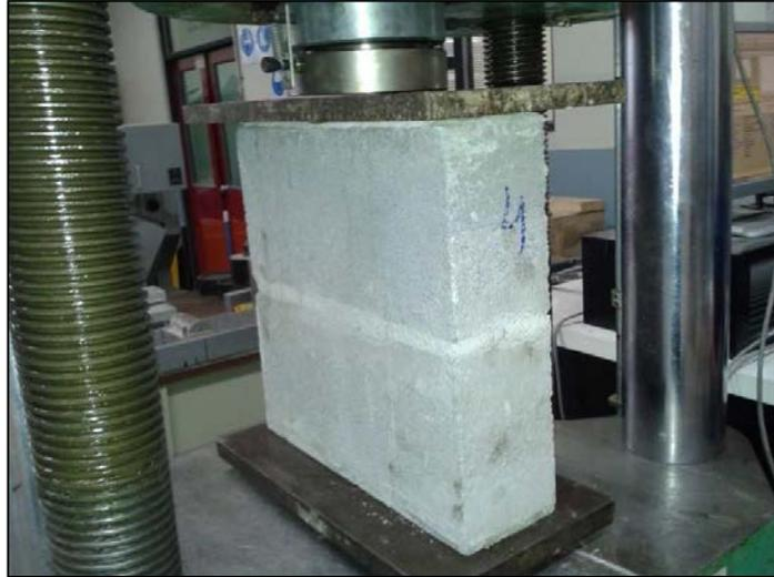
**Figura 7. Prisma de mampostería listo para ser fallado.**
