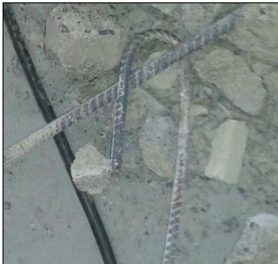
**Figura 95. Resultado de la falla, gancho estándar de 180° deformado, espécimen 3-1.**
