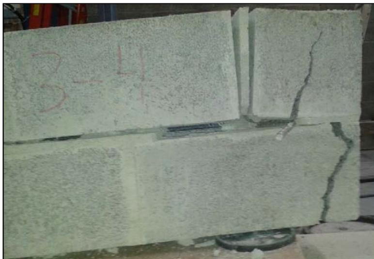
**Figura 103. Especimen 3-4 durante el proceso de falla, el gancho estándar de 180° se deformó.**
