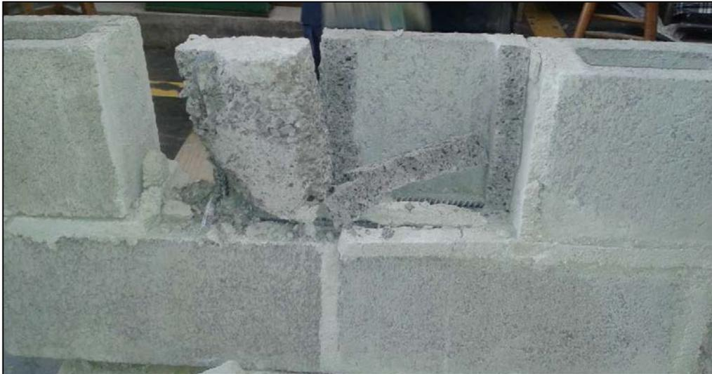
**Figura 126. Espécimen 5-2, durante el proceso de falla.**
