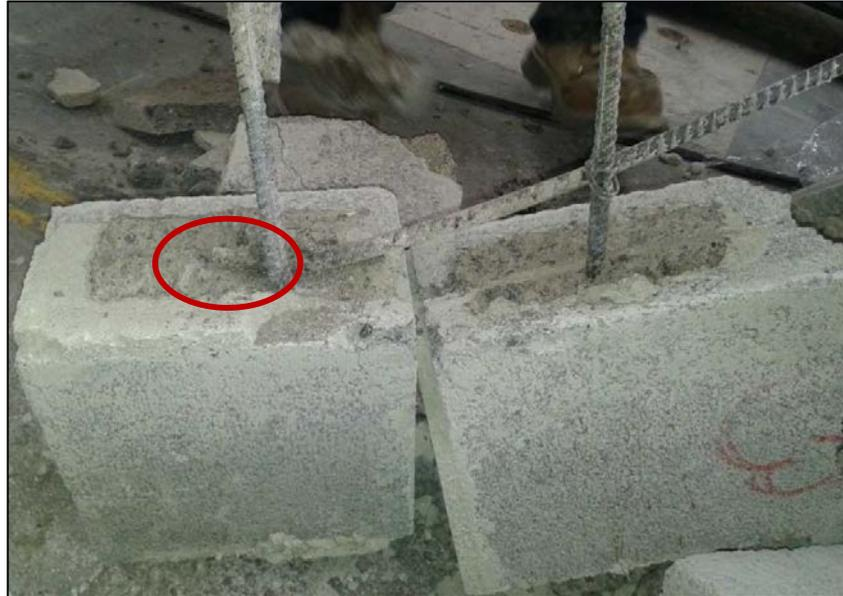
**Figura 87. Resultado de la falla, gancho estándar de 90° deformado, espécimen 2-3.**
