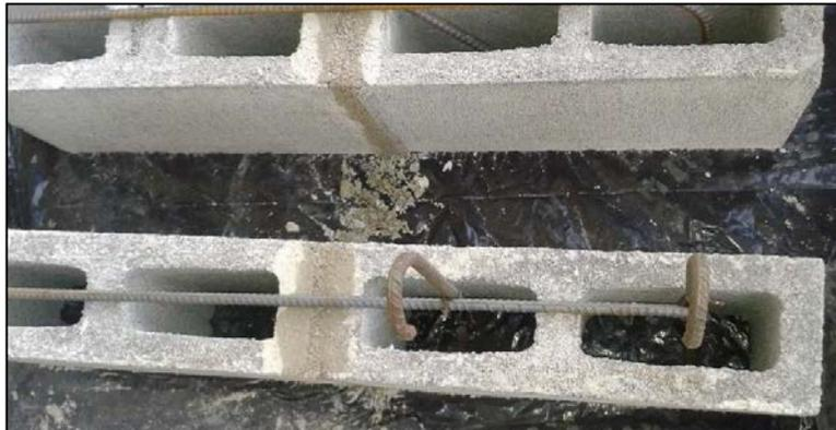
**Figura 39. Segundo extremo de pared, 2 varillas verticales #3 y varilla horizontal #3 con gancho de 90°.**
