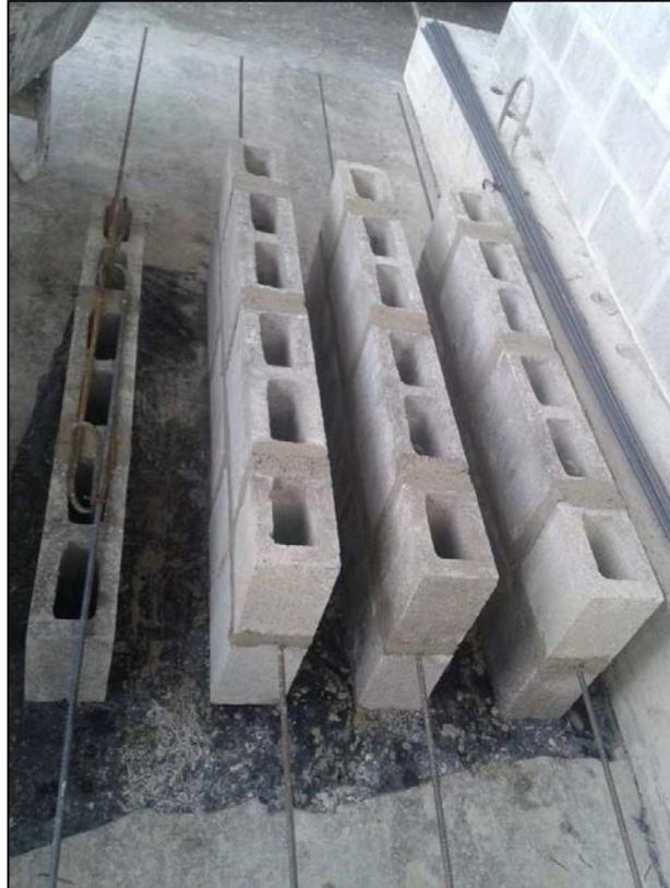
**Figura 50. Especímenes de primer tipo de traslapo en construcción.**
