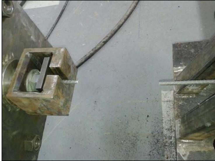
**Figura 143. Resultado de la falla espécimen 6-3, ruptura de la varilla.**
