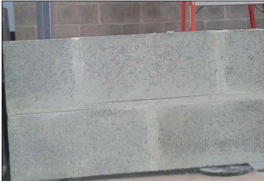
**Figura 100. Espécimen 3-3 durante el proceso de falla, los bloques se empiezan a separar del mortero de pega.**
