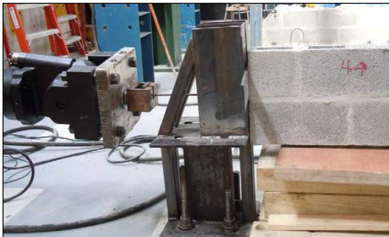
**Figura 116. Especimen 4-4 durante el proceso de falla.**
