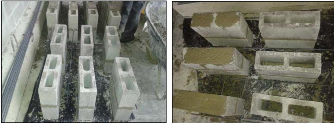
**Figura 6. Prismas de mampostería en proceso de construcción.**
