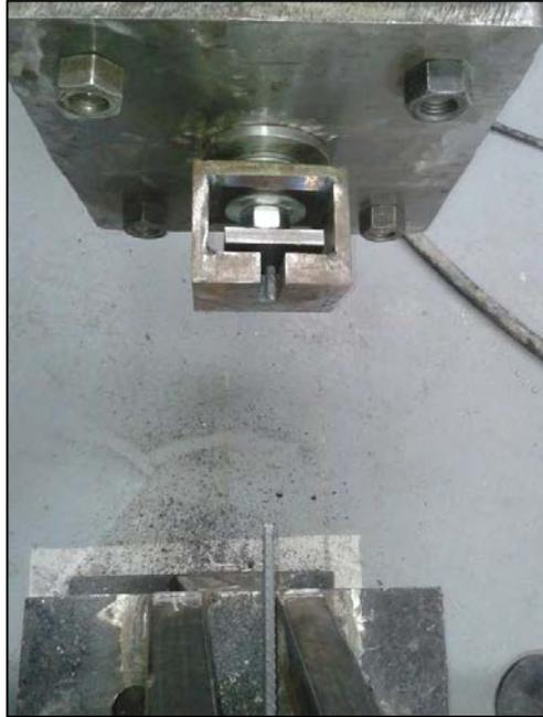
**Figura 149. Resultado de la falla espécimen 6-5, ruptura de la varilla.**
