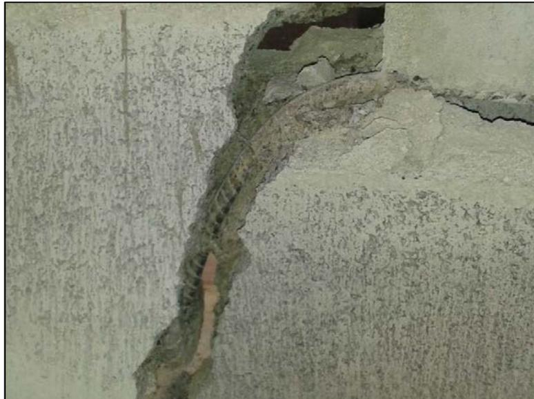
**Figura 65. Resultado de la falla, gancho estándar de 90° deformado, espécimen 1-1.**
