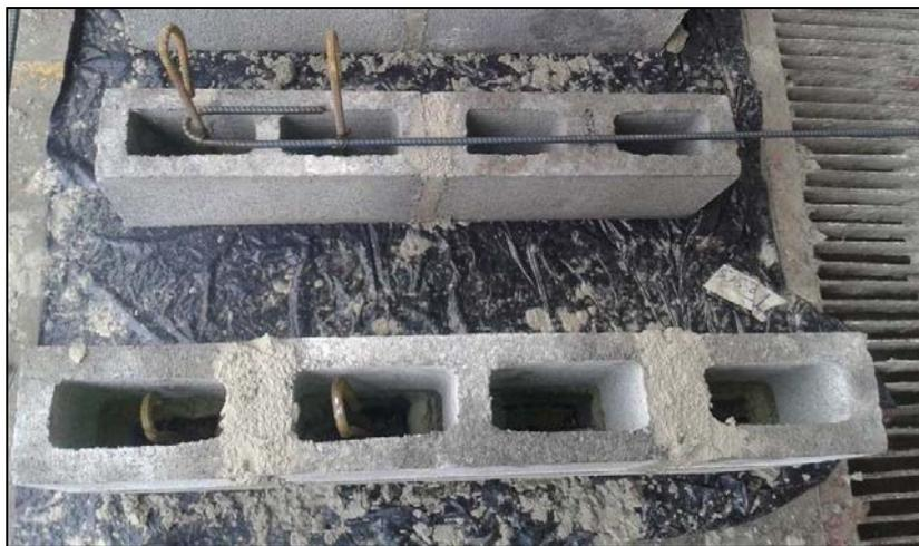
**Figura 46. Especímenes de cuarto extremo de pared en construcción.**
