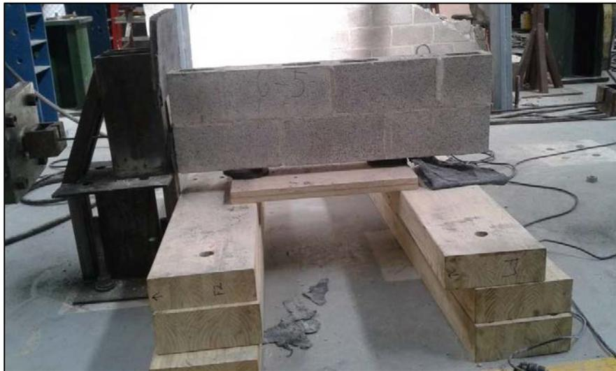
**Figura 148. Especimen 6-5 durante el proceso de falla.**
