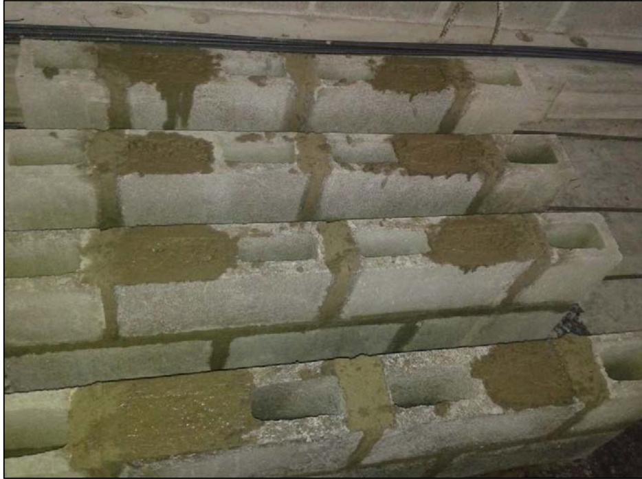
**Figura 54. Especímenes listos con concreto de relleno.**
