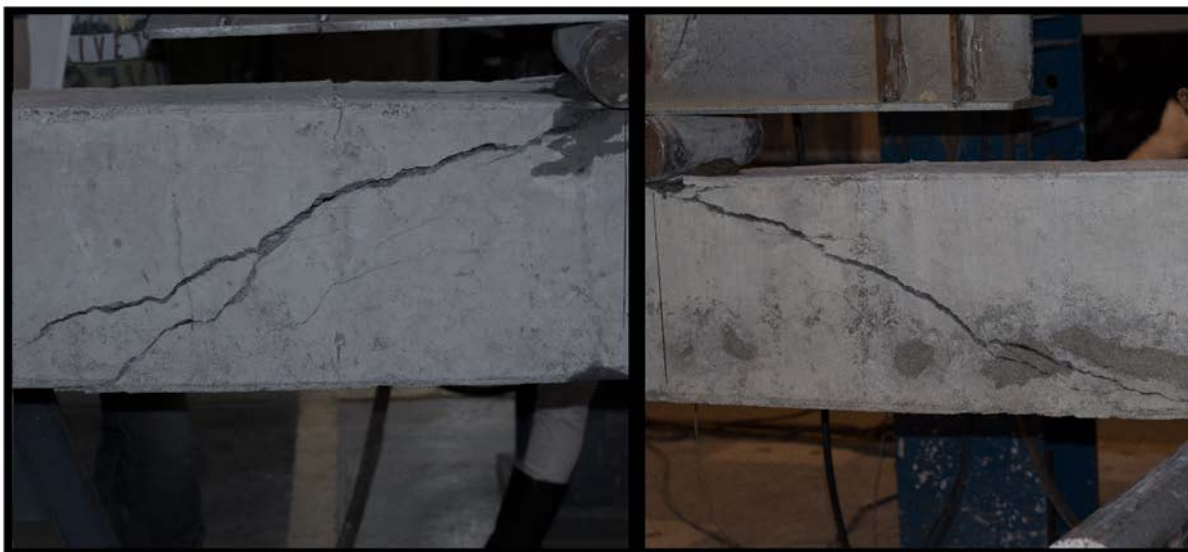
Figura F1. Estado de espécimen V-A después de finalizado el ensayo de falla.
