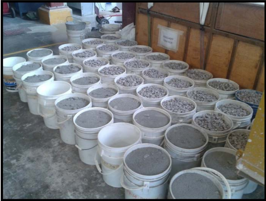
Figura 18. Dosificación por peso de agregados.
