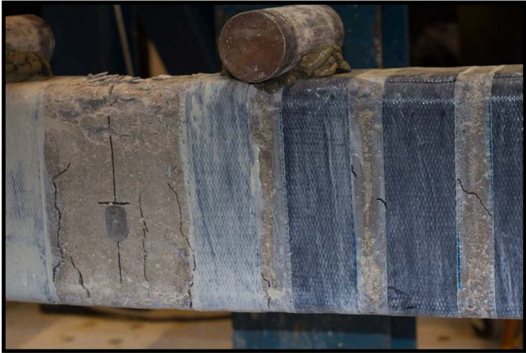
Figura F13. Grietas de flexión observadas en el espécimen VO-4 (resaltadas con marcador).
