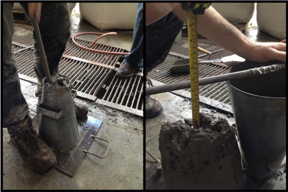
Figura 19. Prueba del cono de revenimiento de Abrams.
