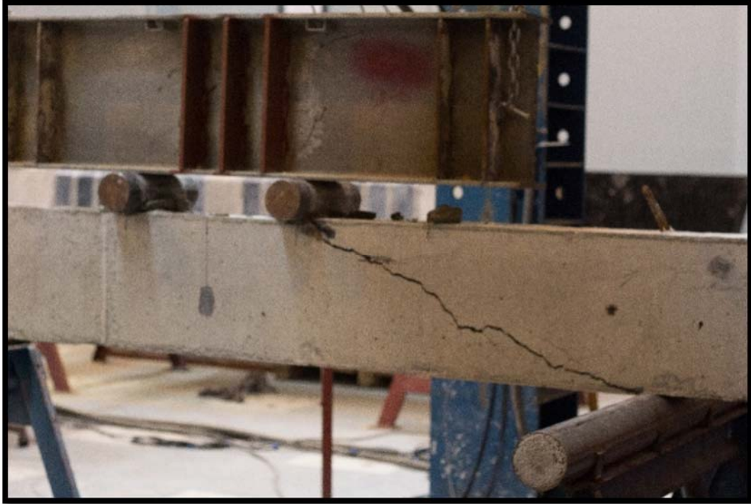
Figura F3. Estado del espécimen V-B después de finalizado el ensayo de falla.
