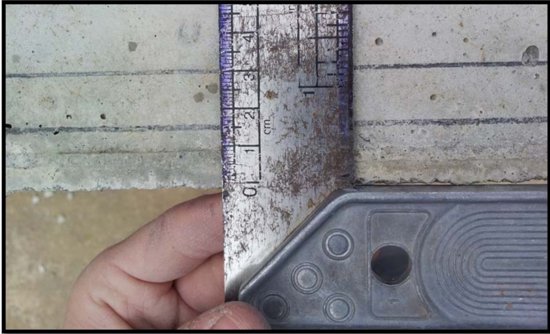
Figura 24. Radio de 30 mm en los vértices de los especímenes.
