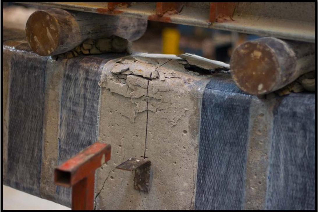
Figura F9. Estado del espécimen VO-3 después de finalizado el ensayo de falla.
