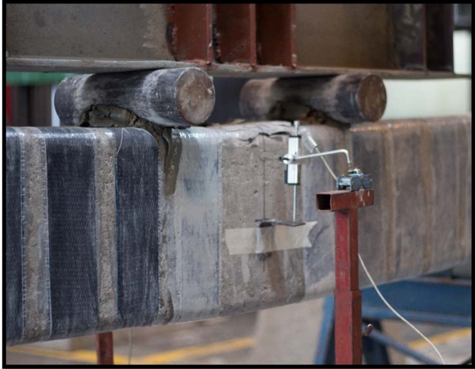
Figura F7. Estado del espécimen VO-2 después de finalizado el ensayo de falla.
