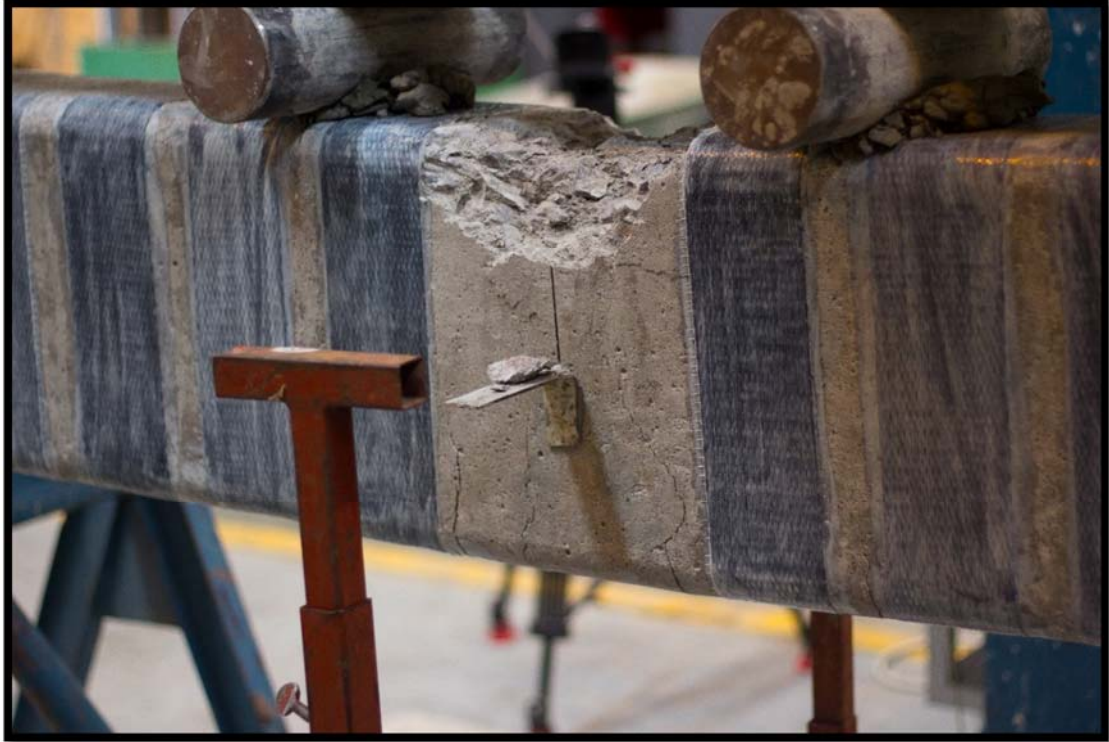
Figura F5. Estado de espécimen VO-1 después de finalizado el ensayo de falla.
