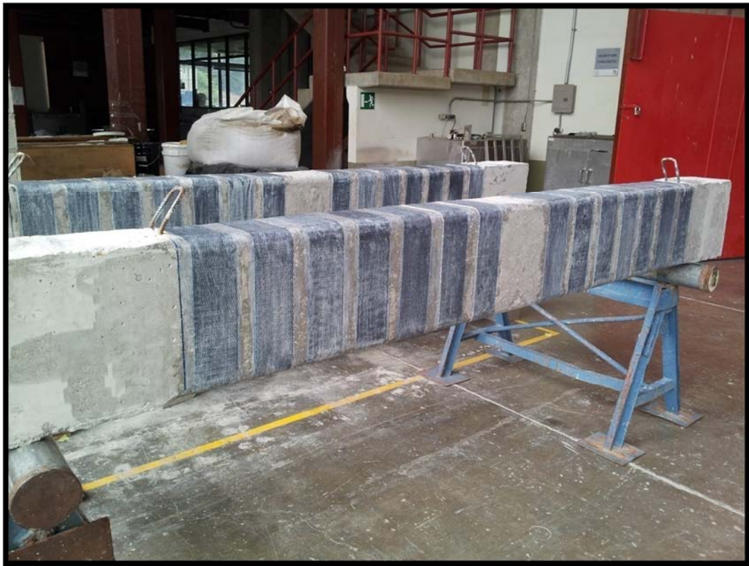
Figura 32. Especímenes de ensayo con sistema de reforzamiento externo de CFRP.
