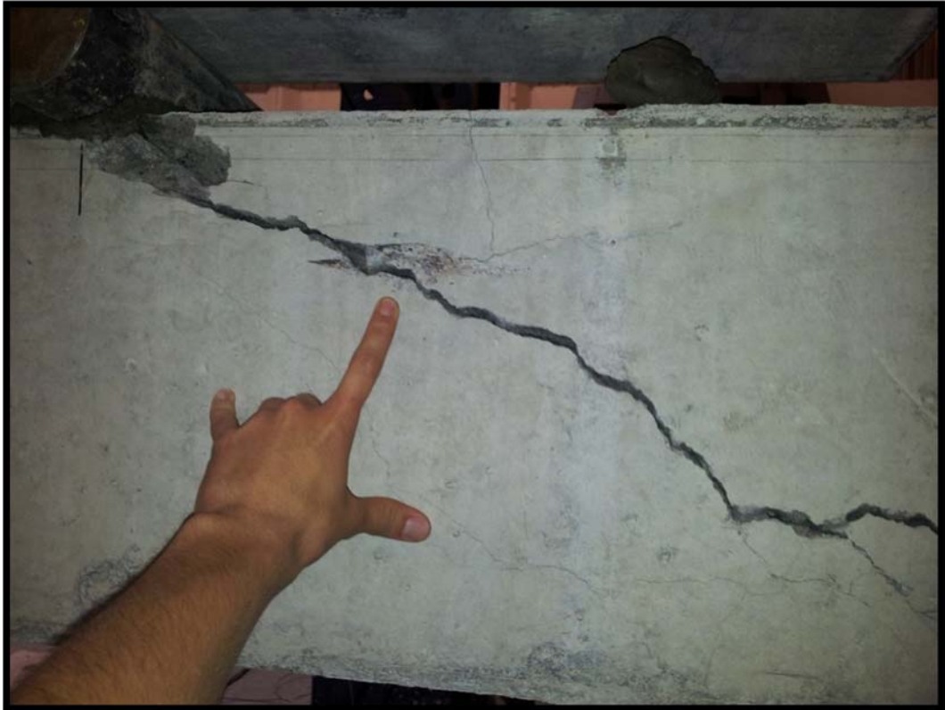
Figura F4. Grietas de cortante observadas en el espécimen V-B después del ensayo de falla.
