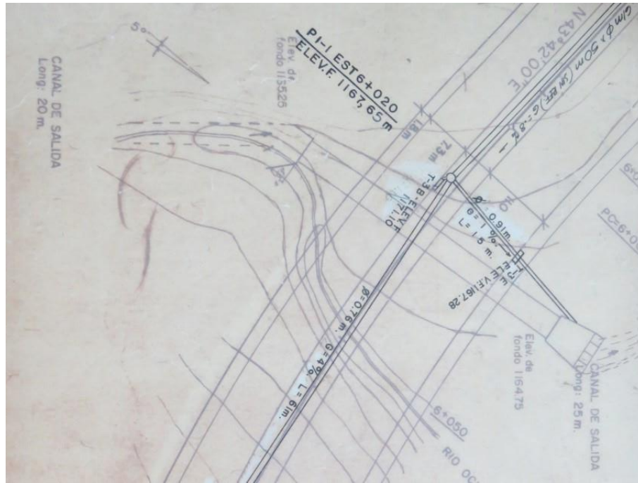
Figura 7-23. Plano de la alcantarilla Ocloro.
