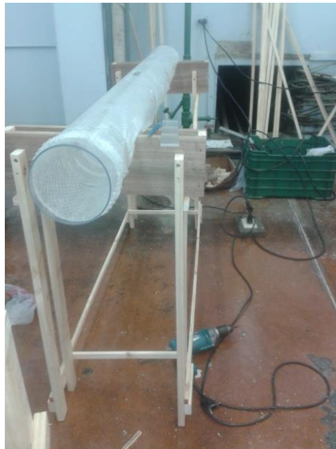
Figura 4.9. Base para la alcantarilla.
