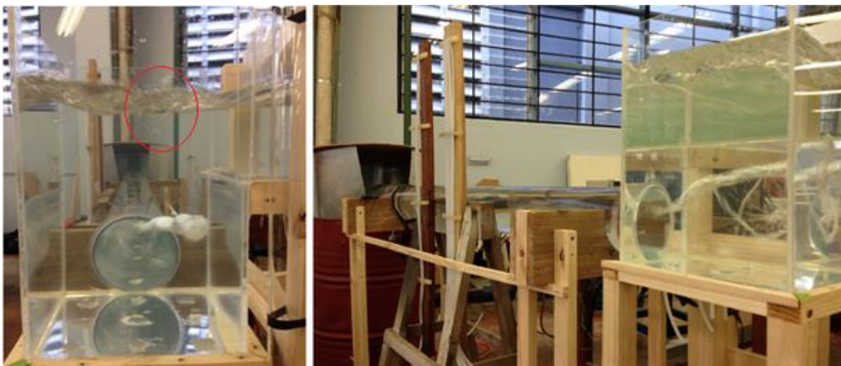
Figura 5.1. Comportamiento del modelo en la primera condición, caracterizada por transportar los caudales altos ( 0.93-0.75 de Q/\sqrt{gD} A).
