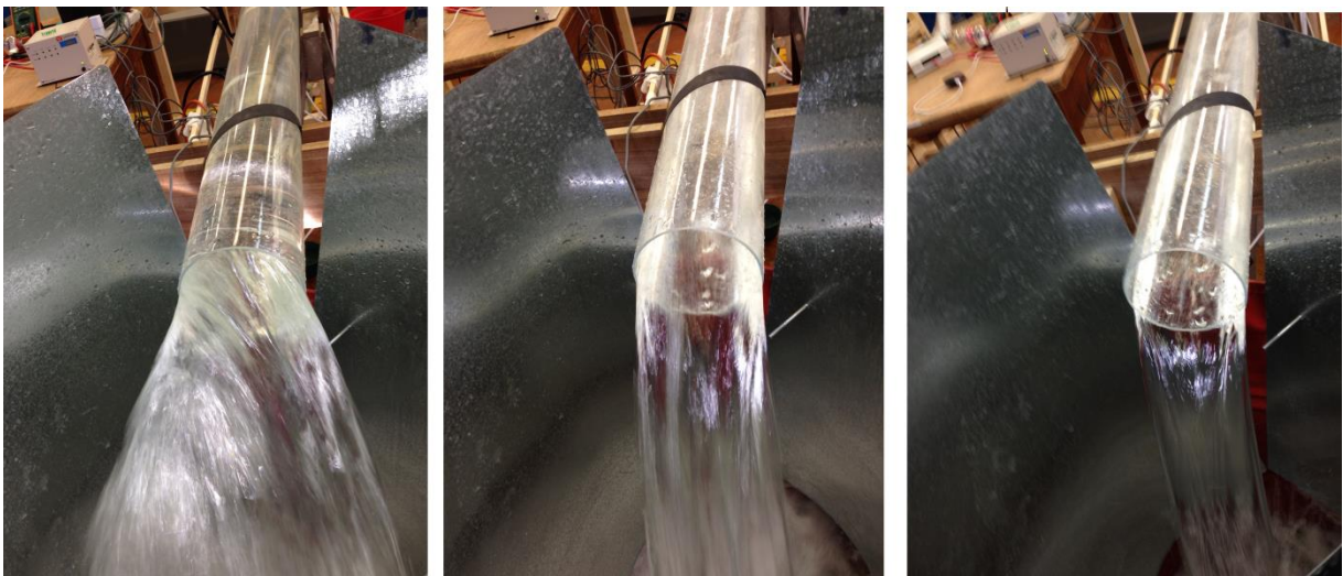
Figura 5.39. Comportamiento del flujo en la salida del modelo, caudales de 0.93\sqrt{gDA} , 0.56\sqrt{gDA} , y 0.37\sqrt{gDA} respectivamente de izquierda a derecha en la imagen.
