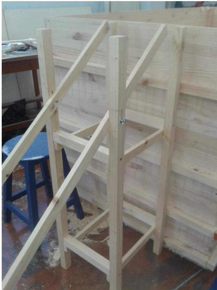
Figura 4.7. Base para la cuneta con modificador de altura para variar pendientes del canal.
