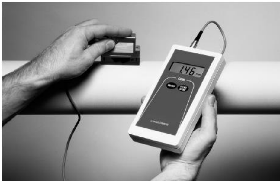
Figura 4.14. Medidor de flujo ultrasónico Omega FD613.
