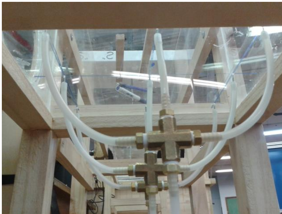
Figura 4.16. Tomas de presión en el fondo del cabezal.
