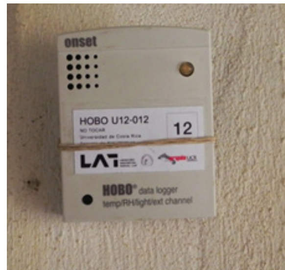
Imagen 4.2: Dataloggers ubicados en las viviendas en estudio. Fuente: Autor
