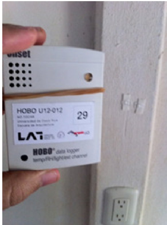
Imagen 3.16: Dataloggers ubicados en las viviendas en estudio. Fuente: Autor
