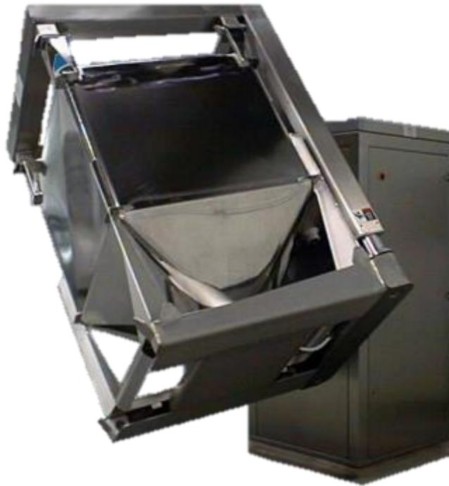
**Figura 2.2.** Módulo de *In Bin Blender* (Matcon IBC, s.f.).
