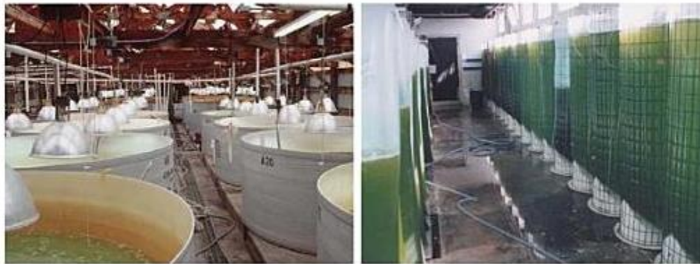
Figura 2.2 Cultivo de microalgas en discontinuo o batch, en tanques de sección circular (izquierda) y bolsas de volumen variable (derecha) (Fernández, 2000).
