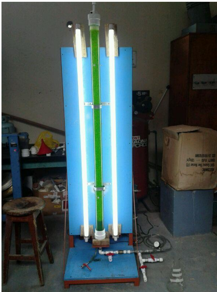
Figura 5.1. Fotobiorreactor construido para la realización del proyecto, tipo tubular vertical.
