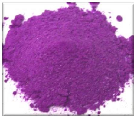
Figura 15. Polvo obtenido a partir de jugo concentrado de pitaya (*Hylocereus* sp.) mediante secado por liofilización.
