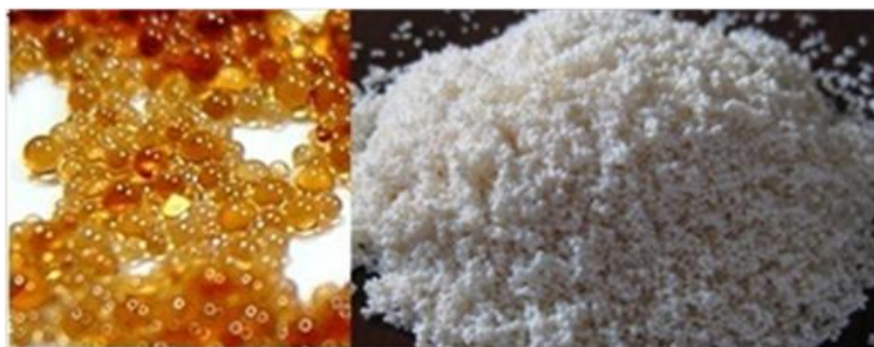
Figura 3. Resina tipo gel 4 (izquierda) y resina macroporosa 5 .
