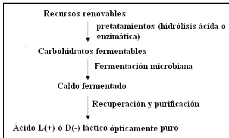
Figura 5. Proceso de producción de ácido láctico por fermentación (Wee et al. , 2006)
