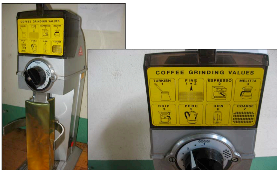
Figura 4.6. Molino utilizado para moler el café y uso de niveles de granulometría dos y tres como niveles usuales para moler café cuando los consumidores lo solicitan para preparar café por métodos tradicionales.
