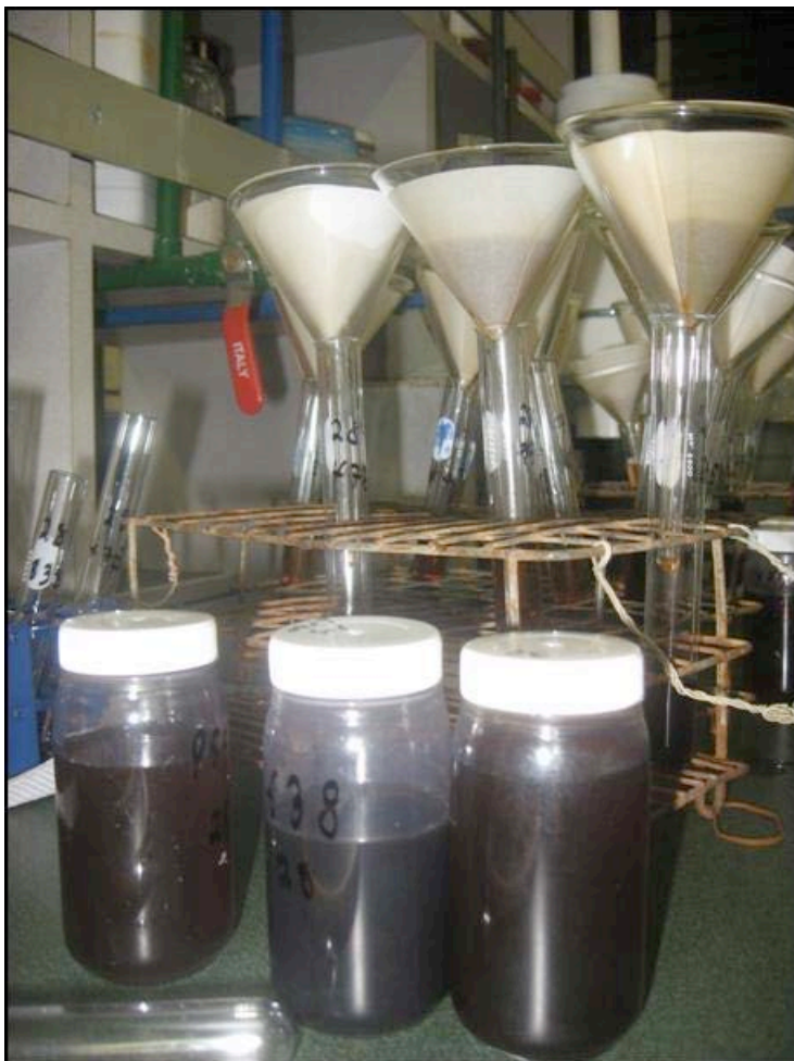
Figura 4.8. Muestras de las bebidas de café preparadas por los panelistas por medio del uso de la bolsita de café, y método de filtrado utilizado para posteriormente medir la absorbancia de cada una de las muestras.
