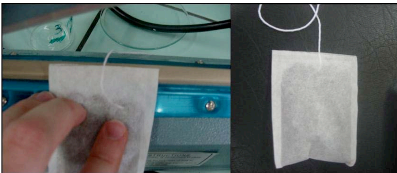
Figura 4.4. Introducción del hilo de pabilo, sellado y presentación final de la bolsita de café.
