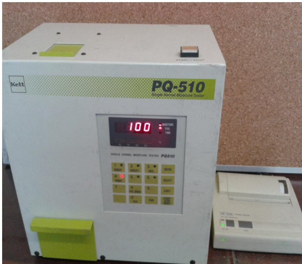
Anexo 2. Determinador individual de humedad de granos Kett PQ-510
