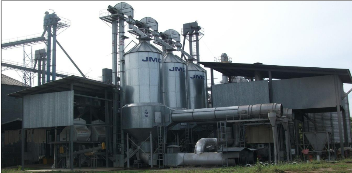
Anexo 1. Secadora recíclica o intermitente marca JMG de la industria arrocera Coopeliberia R.L.
