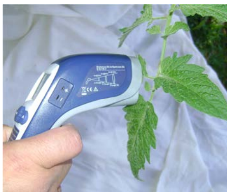
Figura 12. Manera de medir la temperatura con el termómetro infrarrojo.
