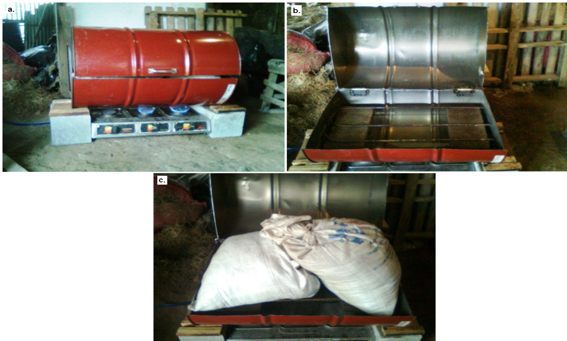
Figura 19. Proceso de pasteurización del compost, a. Equipo en funcionamiento; b. Vista interna del equipo; c. Compost listo para la pasteurización.
