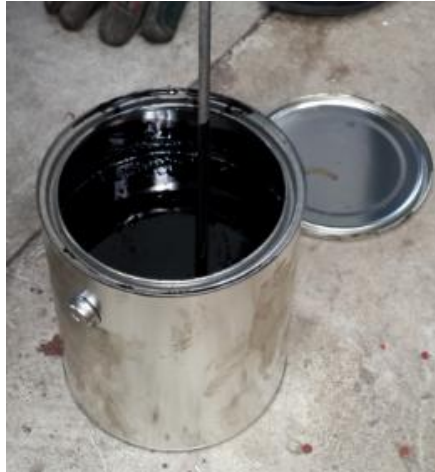
Figura 4.11. Recipiente metálico utilizado para modificar el asfalto con caucho.
