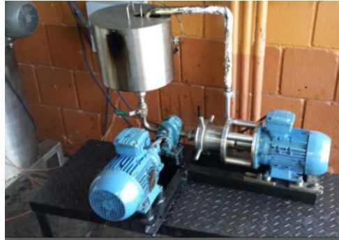
Figura 4.8. Planta piloto de emulsión asfáltica.
