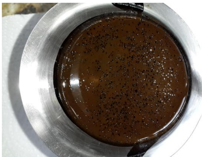
Figura 4.15. Emulsión asfáltica modificada al 1 % m/m de caucho.
