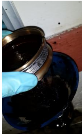
Figura 4.14. Ensayo de masa retenida en la malla N° 20 de la emulsión asfáltica modificada al 1 % m/m
