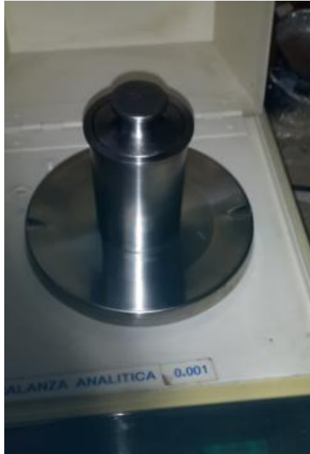
Figura 1.10. Picnómetro utilizado en la prueba de densidad.
