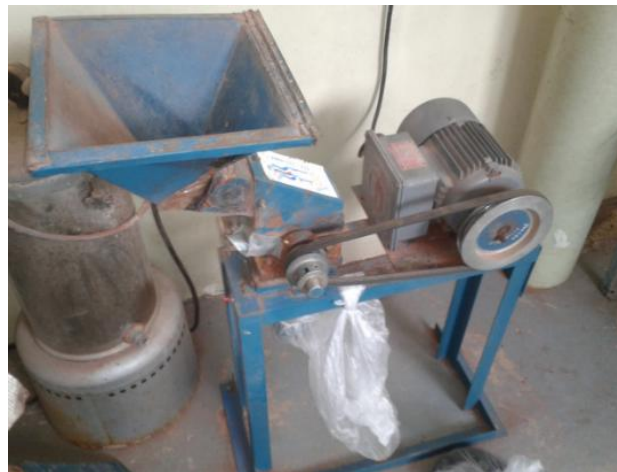
Figura 4.6. Molino utilizado para el proceso de criogénesis.
