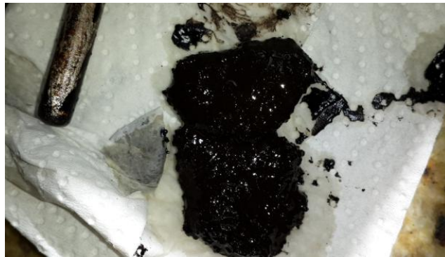
Figura 4.13. Residuo de emulsión asfáltica modificada al 3 % m/m de caucho, que quedó depositado en la malla N° 20.
