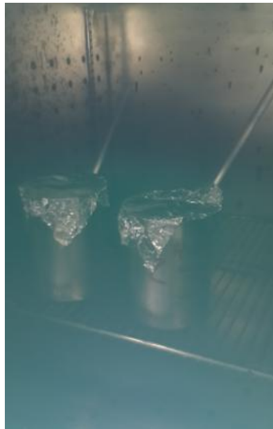
Figura 1.12. Prueba de evaporación de emulsión asfáltica.
