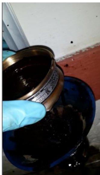
Figura 1.14. Ensayo de malla N° 20.
