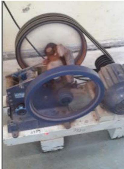
Figura 4.5. Trituradora de mandibula utilizada en el proyecto.
