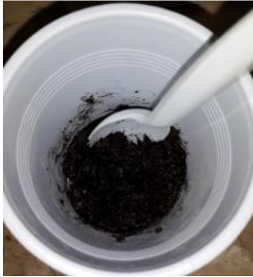
Figura 4.10. Mezclado de la tercera emulsión asfáltica con el agregado nuevo de granulometría tipo 2 para elaborar una lechada asfáltica.
