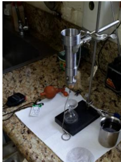
Figura 1.11. Prueba de viscosidad de una emulsión asfáltica.
