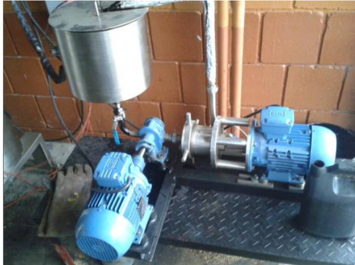
Figura 1.8. Planta piloto para la elaboración de emulsiones asfálticas y modificación de asfaltos PRM-100.
