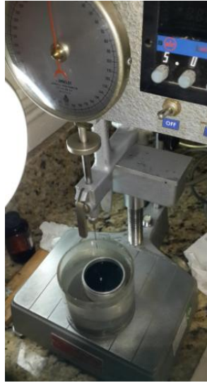
Figura 1.13. Ensayo de penetración.
