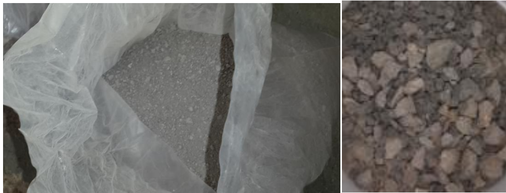
Figura 4.1. Arena industrial utilizada como material pétreo para elaborar las lechadas asfálticas.
