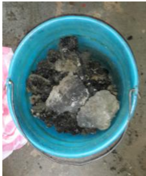
Figura 4.4. Pavimento reciclado utilizado en el proyecto.
