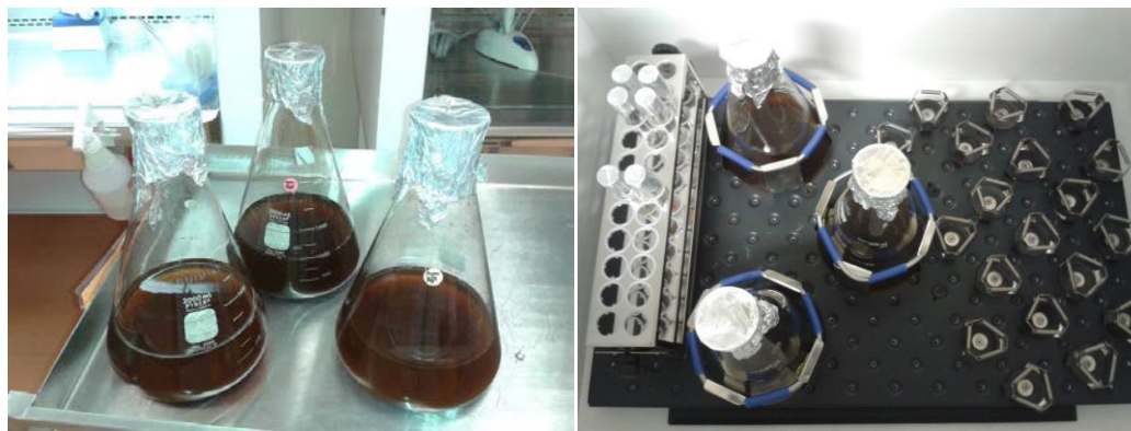
Figura 8.13 Preparación del medio de cultivo para su posterior esterilización a. disoluciones de melaza con una concentración de 30 g por litro de agua peptonada b. crecimiento de melaza en el agitador con control de temperatura.
