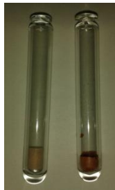
Figura 7.1 Indicador físico marca DIACK a la izquierda sin derretir y a la derecha derretido después de un proceso de esterilización
