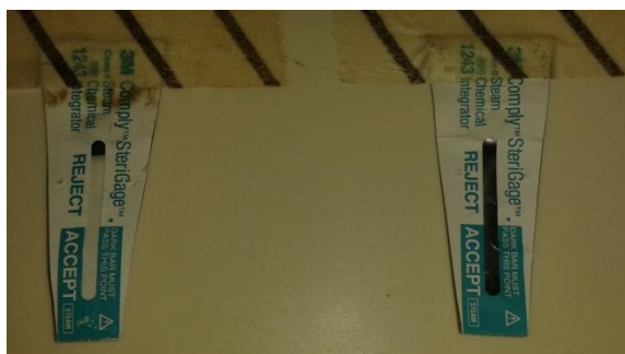
Figura 7.2. Indicadores físicos químicos marca 3M a la izquierda un resultado negativo para esterilización en el interior del biorreactor, a la derecha un resultado positivo para esterilización en el exterior del biorreactor
