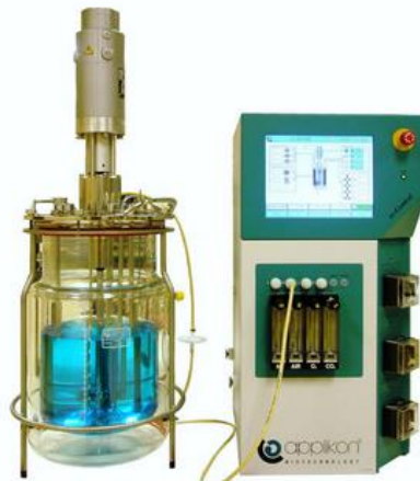
Figura 5.1 Biorreactor de 15 litros y equipo de control automático Fuente: (Tomado de: cenibiot.go.cr)
