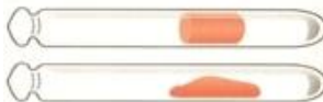
Figura 4.2 Monitores físicos: antes (arriba) y después (abajo) de la esterilización a 121 °C Fuente: (diakinc.com)
