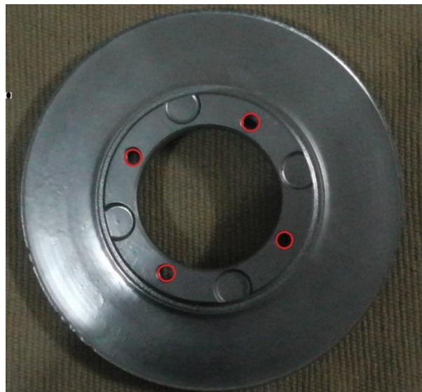
Ilustración 38. Agujeros de soporte disco de freno (Autores, 2014)
