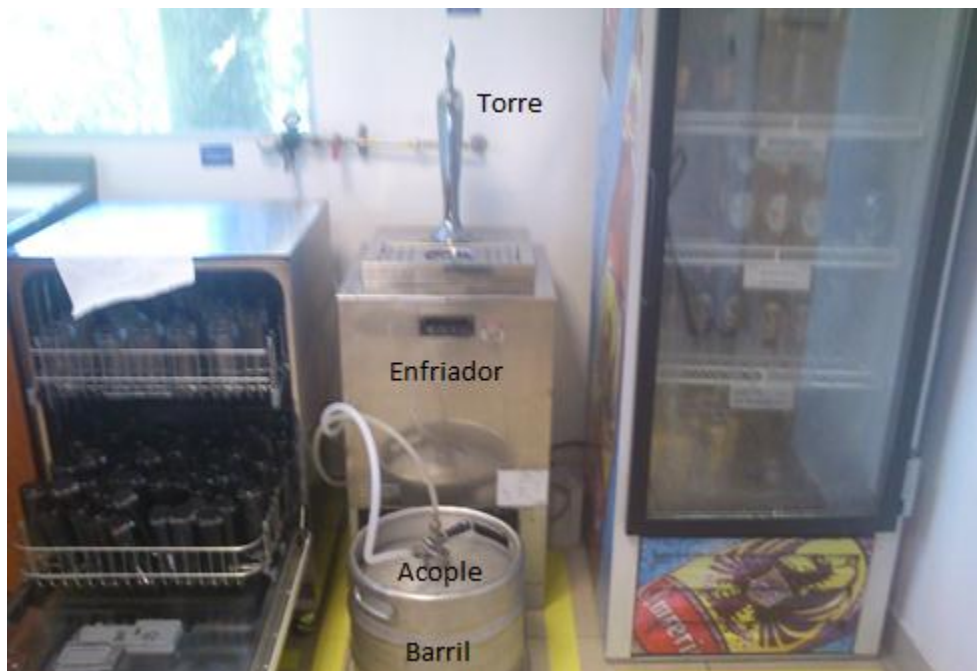
Figura 2.2 Equipo de enfriamiento y dispensación de cerveza de tipo “fast chiller”.
