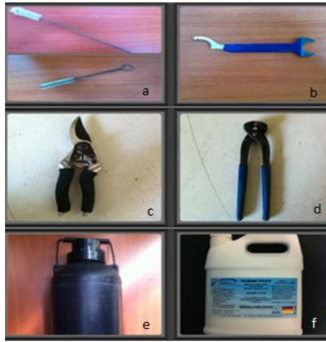
Figura 3.2 Herramientas necesarias para llevar a cabo el mantenimiento de los equipos a) cepillos cilíndricos b) Llave para grifo c) Cortadora de manguera d) Tenaza e) Lechera f) Desinfectante.
