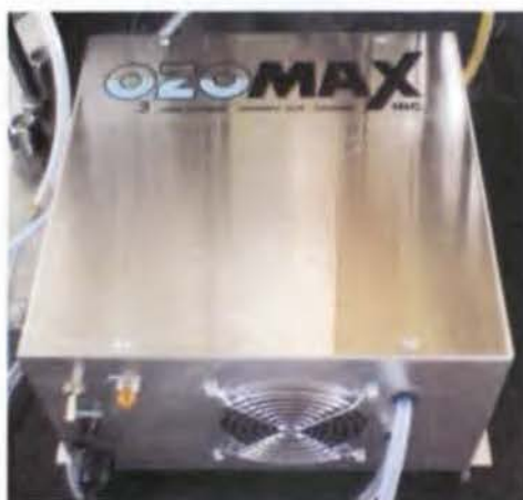
Figura 5.5 Generador de Ozono utilizado.
