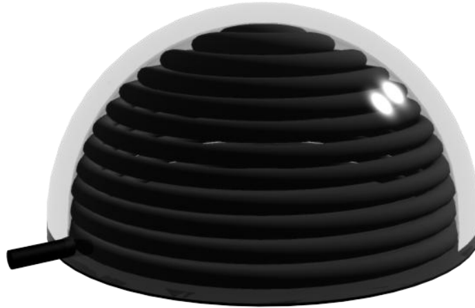
Figura 8. Colector solar esférico.
