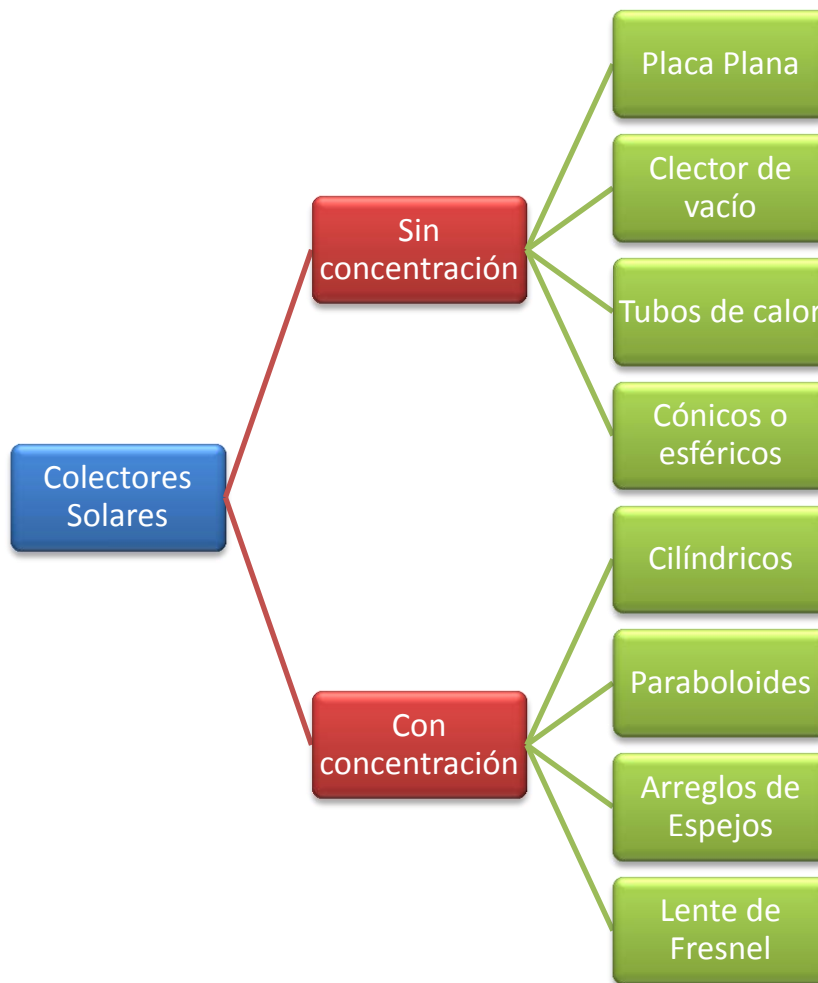
Figura 4. Tipos de colectores solares disponibles en el mercado
