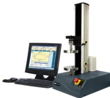
Figura 6.3. Representación del equipo de pruebas de tensión utilizado en el análisis de los tratamientos superficiales del ETFE. (Instron, 2013).
