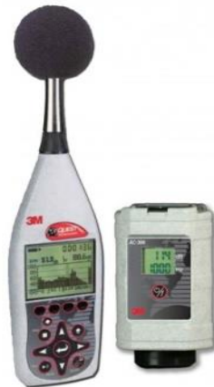
Figura 2. Sonómetro integrador Marca 3M, modelo Sound Pro Fuente: Certifica Security Bay, 2019.
