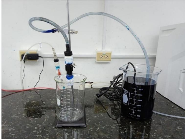
**Figura 5.5.** Sistema para evaluación de la capacidad de adsorción de los filtros diseñados.
