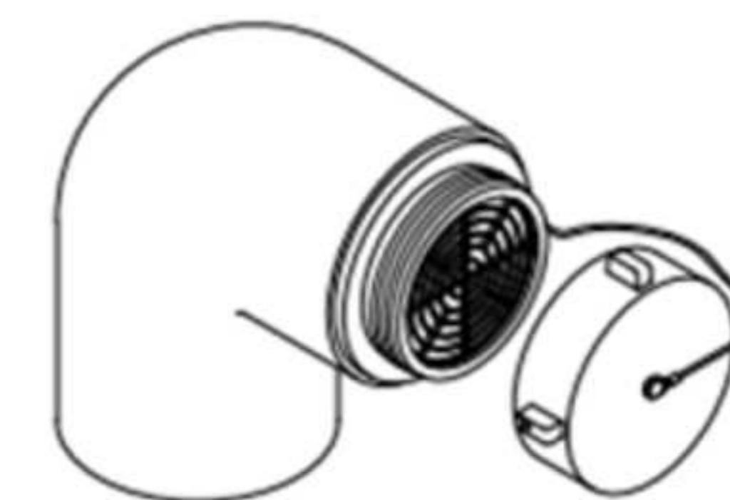
Detalle de toma directa con rosca macho 4 1/2" NST
