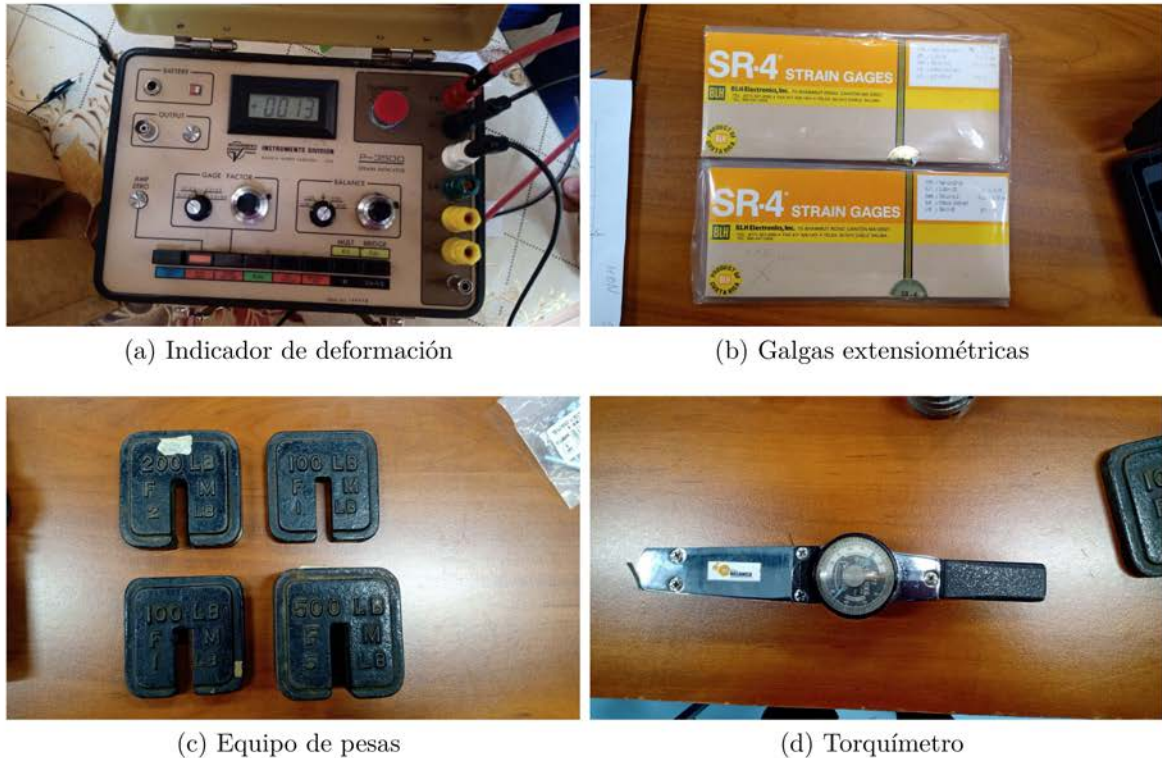
Figura 5.3: Equipo de medición utilizado en pruebas de deformación. Fuente: Elaboración propia.
