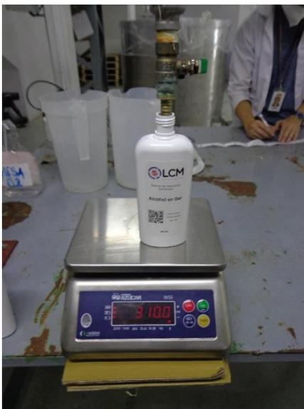
Figura 21: Arreglo de balanza a nivel de la tubería conectada a la tina, con el ítem del CMR pesando 310.0 g de muestra por envasado utilizado.
