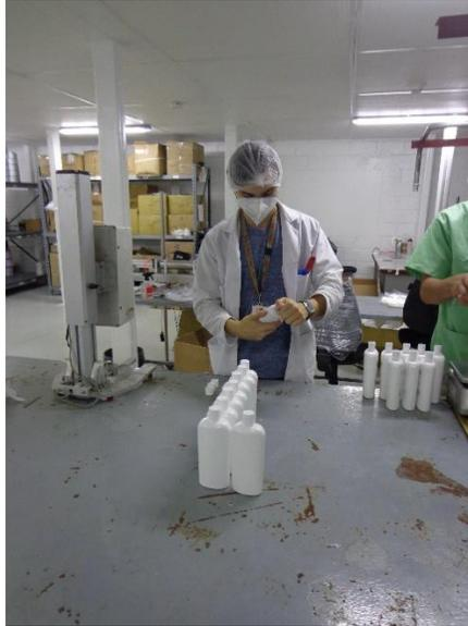
Figura 22: Encargado de producción tapando las botellas para proceder a sellar con *liner* inductivo.
