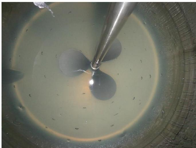
Figura 20: Propela de aspas utilizado para la agitación posterior a la adición de las cargas, propuesto para garantizar mayor homogeneidad del lote fabricado. Tiempo de agitación: dos horas.
