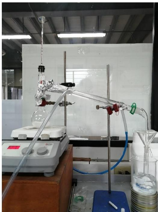
Figura 24: Sistema de destilación simple utilizado en Sur Química para la destilación de las muestras. Las mangueras del condensador se encuentran unidas a un recirculador con agua helada.
