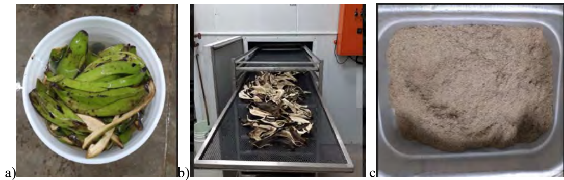
Figura 19. Obtención del sustrato de extracción a partir de cáscaras de plátano verde: a) inmersión en ácido cítrico, b) secado, c) cáscara plátano seca y molida (CS).
