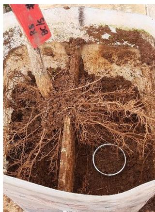
**Figura 8.** Muestreo utilizado para determinar la retención de humedad del suelo en un hemipote. Obsérvese el anillo de acero utilizado para estimar esta variable en el hemipote derecho de la fotografía.
