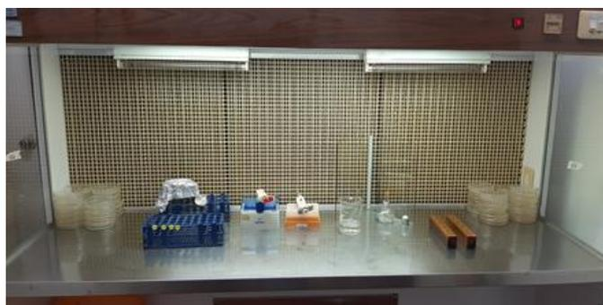
**Figura 7.** Cámara de flujo laminar modelo 6HC-24 utilizada para el recuento de la Unidades Formadoras de Colonias (UFC) en placas.
