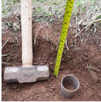
**Figura 6.** Muestreo de densidad aparente en finca Salmebre a una profundidad de 0 a 20 cm.
