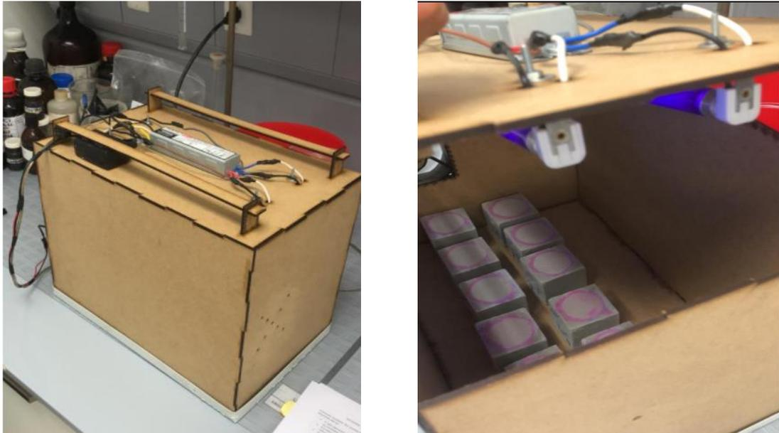
**Figura 4.6.** Equipo de trabajo, ensayo de exposición de las probetas a luz UV (Elaboración propia).
