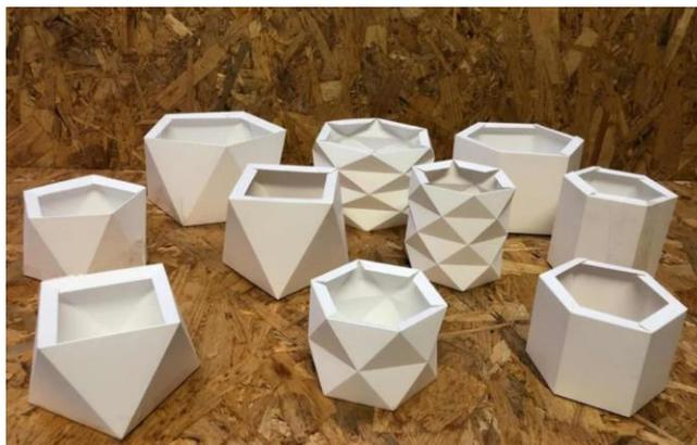
**Figura 5.17.** 10 moldes de polipropileno laminado para hacer macetas de concreto de dimensiones 7 cm x 10 cm x 10 cm aproximadamente (Duane Diseño Vivo, n.d.).
