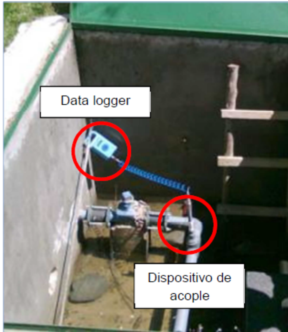
Figura 7.4: Esquema de instalación del data logger.(Abarca, 2012)
