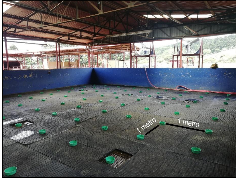
Figura 6. Medición de coeficiente de uniformidad del riego aplicado
