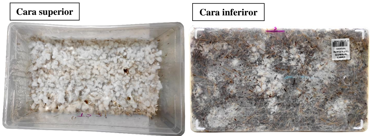
Figura 4. Fotografías tomadas de la cara superior e inferior del biofiltro con micelio de Pleurotus ostreatus y heno ( Digitaria eriantha ). Se utilizaron para ser analizadas mediante el software ImageJ 1.8.0_112 para calcular el área abarcada por el micelio. Estas fotografías muestran el quinto día de crecimiento del micelio.
