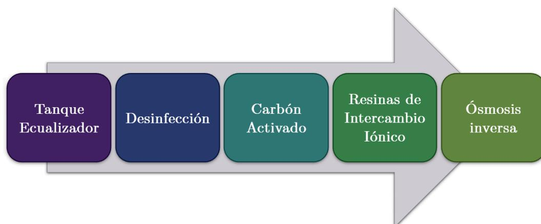
**Figura 6.31.** Sistema propuesto para el reúso de las aguas residuales provenientes del proceso productivo.
