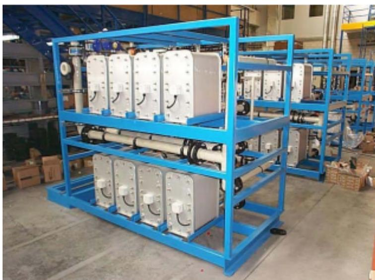
**Figura 6.25.** Vista de un sistema modular de electrodesionización en continuo. Fuente: Sanz *et al.* (2006)
