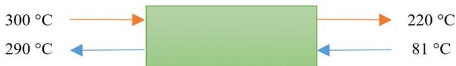
**Figura 3.23.** Cumplimiento de la diferencia de temperaturas en los extremos del intercambiador de calor colocado abajo del pellizco, para un  $\Delta T_{min}$  de 10 °C.
