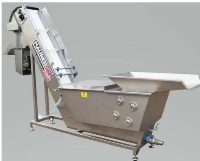
**Figura 4.24.** Lavadora de vegetales propuesta para el proceso de acondicionamiento del rastrojo de piña (Maurer Gep Kft, 2021).
