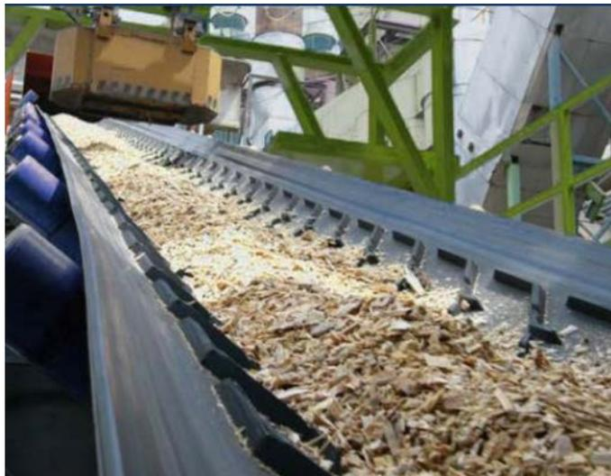
**Figura 4.27.** Banda transportadora propuesta para el proceso de transporte del rastrojo de piña (FORECH India Private Limited, sf).
