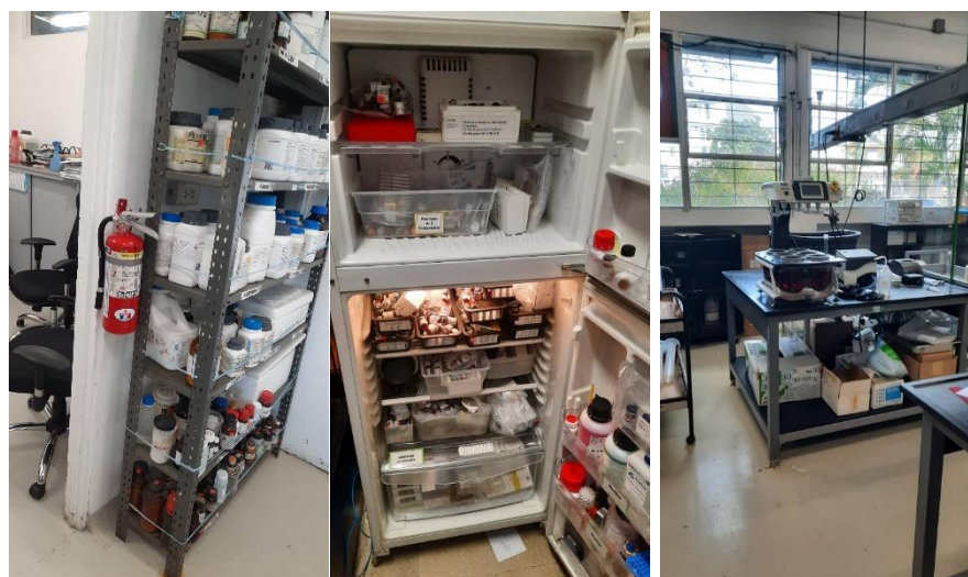
Figura E.25 Fotografías de un extintor mal colocado, almacenamiento de reactivos, refrigerador e instalaciones de laboratorio en LAYAFA.
