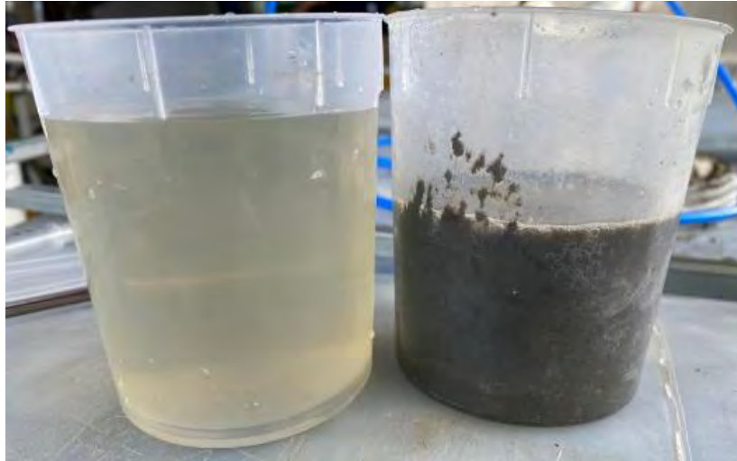
Figura 26. Resultados obtenidos del agua residual antes (derecha) y después (izquierda) del proceso primario de flotación por aire disuelto.
