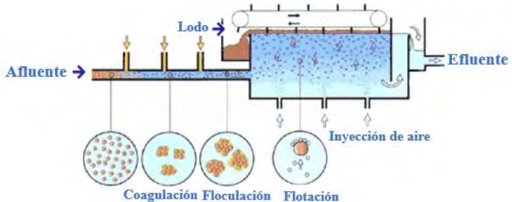
Figura 2. Funcionamiento del equipo de flotación por aire disuelto (Partner S.A., 2018).
