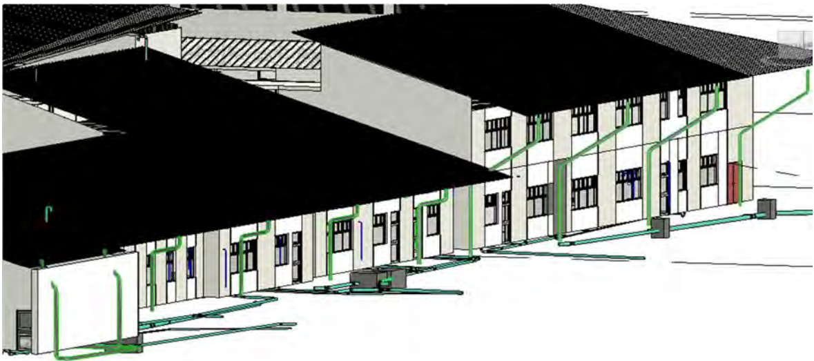
Figura 42. Federación de elementos mecánico-arquitectónico
