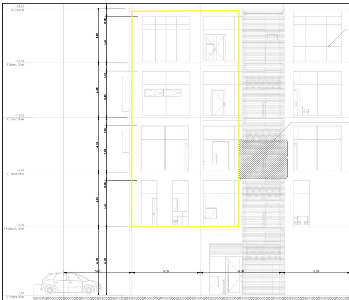
Figura 11. Área propuesta con parasoles en fachada Oeste
