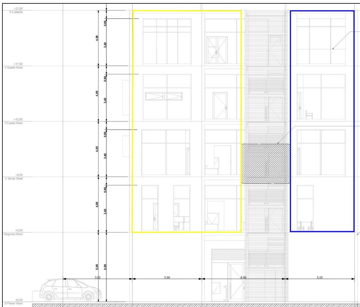
Figura 14. Área de parasoles y pared viva en fachada Oeste (posterior)
