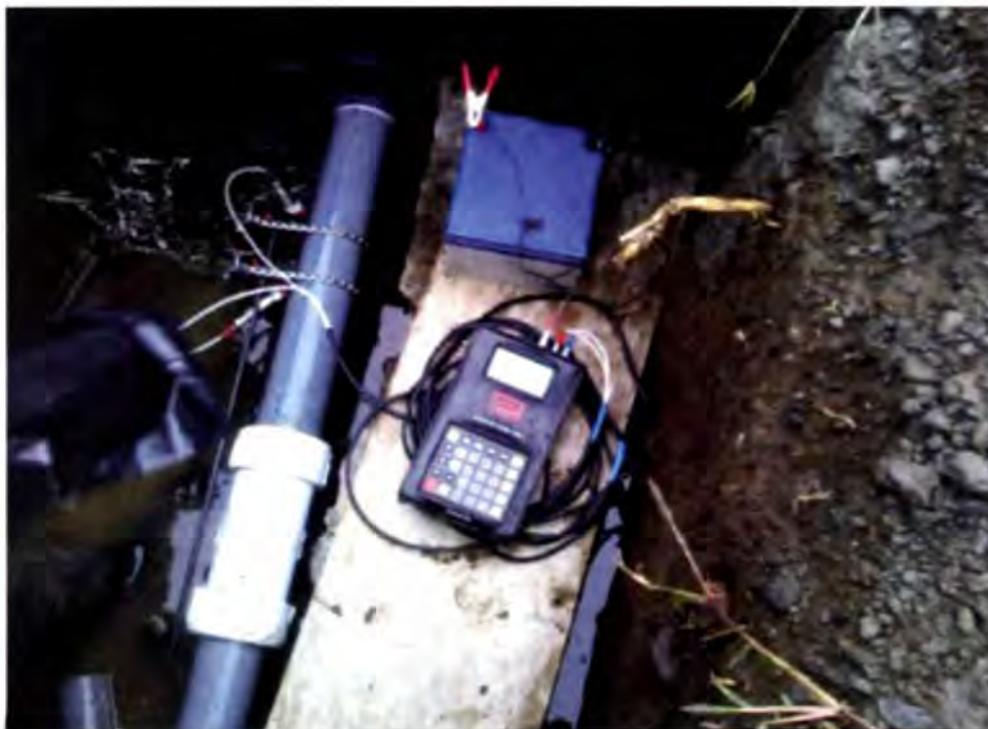
**Figura 3-9. Medición de Caudal a la salida del tanque hacia el pueblo.**
