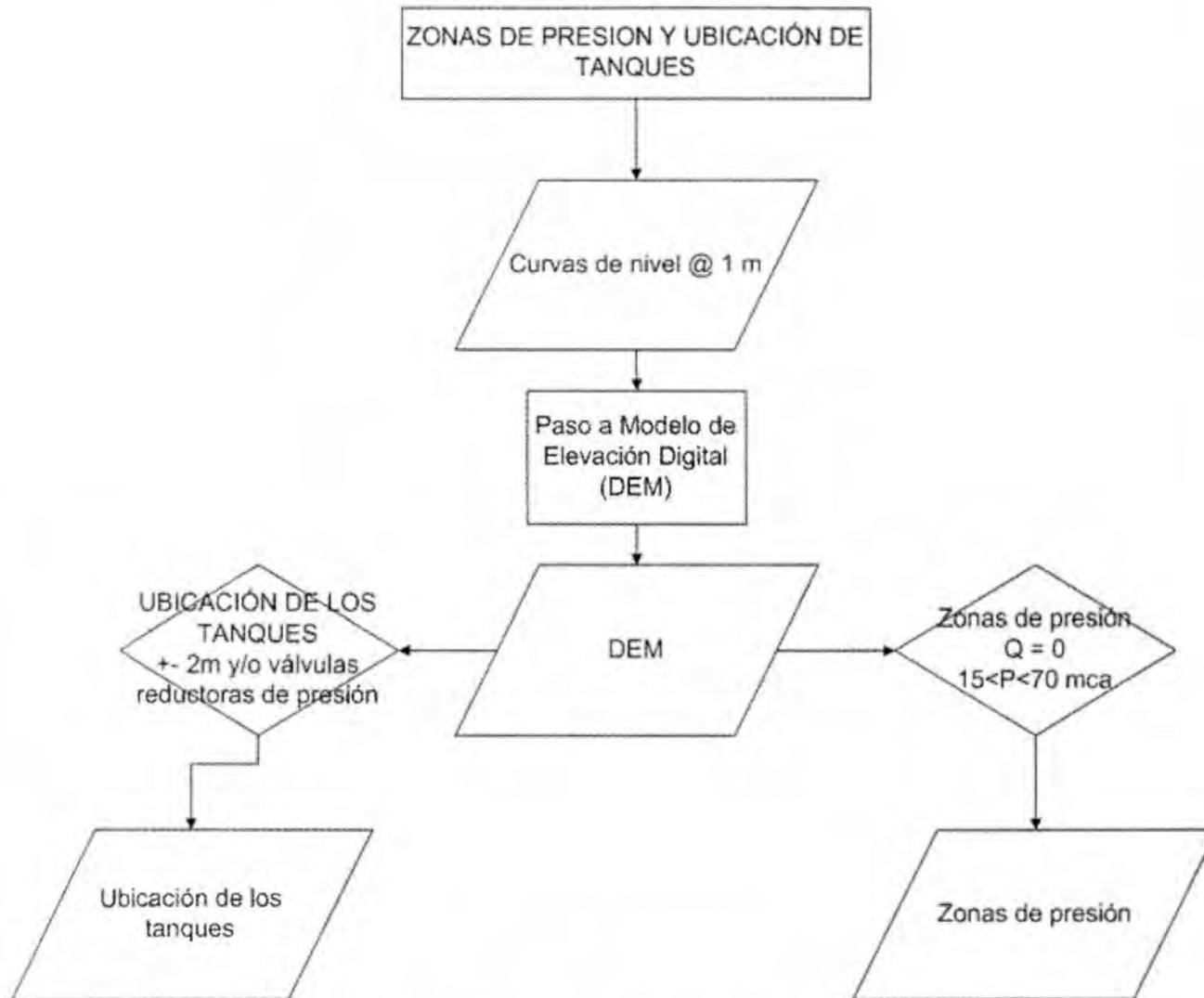
Figura 5-4. Diagrama uso de capas de información para la toma de decisiones en el diseño del acueducto.
