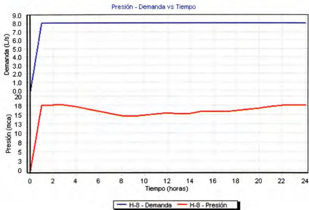
**Figura 5-27. Curvas presión - caudal para el hidrante a colocar frente a la Hacienda.**
