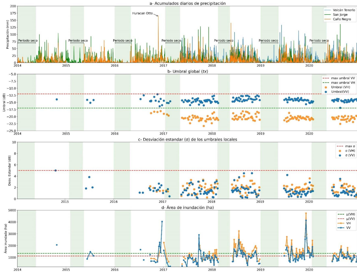
Figura 3.1. Resultados del algoritmo KI para la serie temporal 2014-2020 de imágenes SAR de Sentinel-1 en la CHRf. a) acumulados diarios de precipitación en mm. b) Umbral global \tau_x . c) desviación estándar ( \sigma ) de los umbrales locales. d) área inundada en hectáreas. Fuente: Elaboración propia a partir de imágenes Sentinel-1 y datos de precipitación del IMN.
