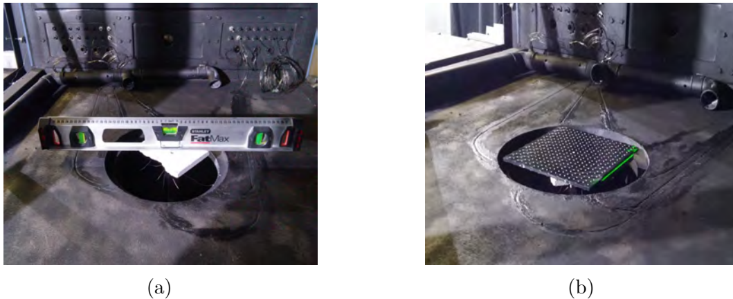
FIGURE A.3 – Procédure de calibration des caméras. Mise à niveau du plan de la mire en (a) et alignement de la mire avec la nappe laser sur le plan de mesure en (b).
