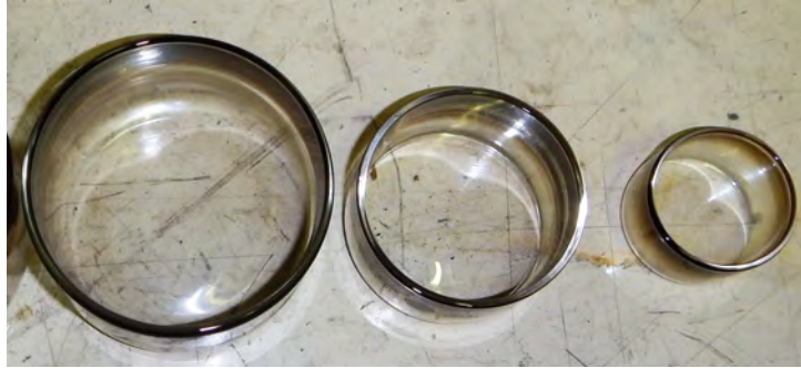
FIGURE 5.1 – Bacs en pyrex de 80, 60 et 40 mm de diamètre respectivement.
