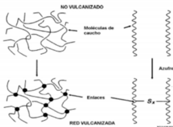
**Figura 2.2.** Cambio estructural ocuriente en las moléculas de un caucho con y sin el proceso de vulcanización (Yepes *et al.*, 2017).
