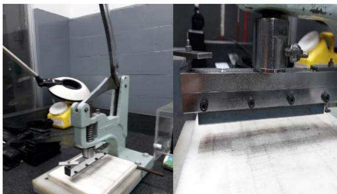
**Figura 4.8.** Guillotina y cuchilla con líneas guías, utilizada para el corte de la muestra.
