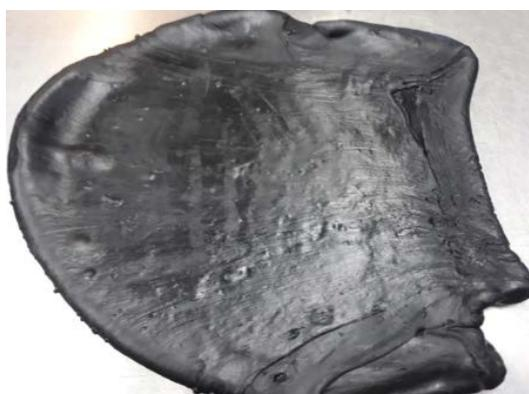
**Figura 4.3.** Lámina de hule posterior al proceso de molineado.
