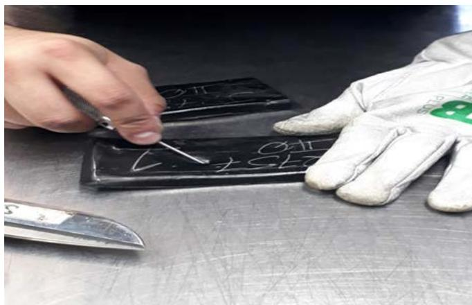
**Figura 4.5.** Eliminación de burbujas en la muestra recortada, según dimensiones establecidas.
