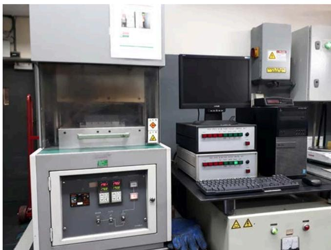
**Figura 4.6.** Equipo de medición del Blow Point.
