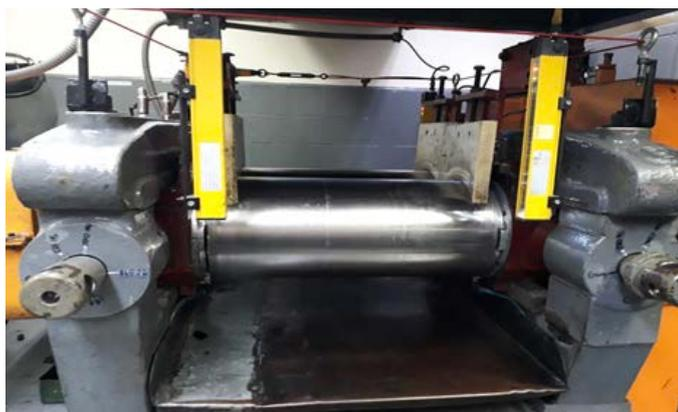
**Figura 4.2.** Molino utilizado para la preparación de la banda lisa de hule.
