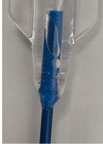
Figura 4.13. Muestra #4 con presencia de burbujas en la unión de los componentes
